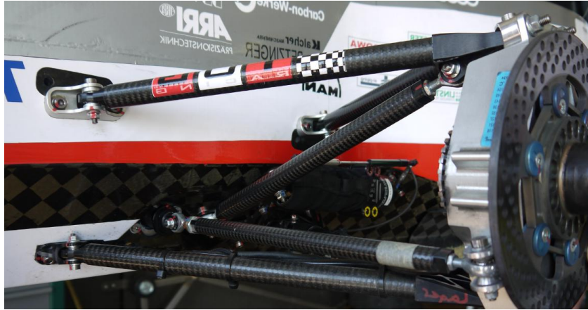
54. ábra: Lengőkar bekötés változtatása a valóságban
