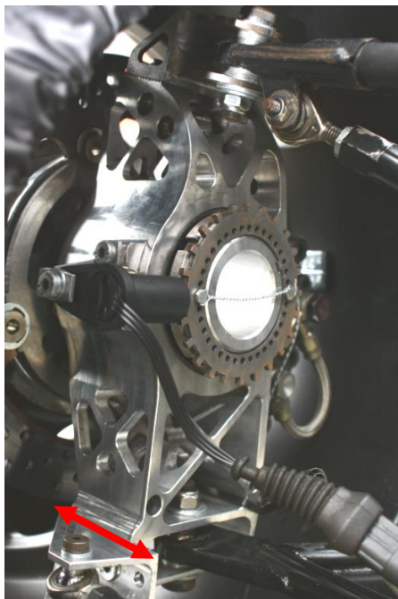
62. ábra: Ackerman geometria állítás a valóságban és a modellben
