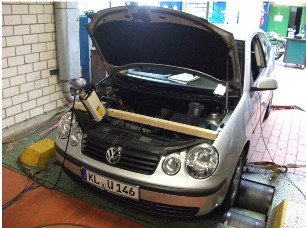
20. ábra A VW Polo motornyomatékának fékpadai mérése
