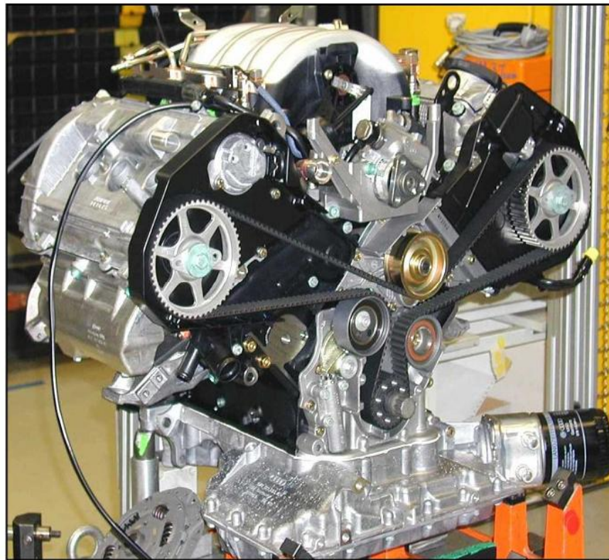
5. ábra Egy AUDI V-motor fogazott szíjas vezérműhajtása
