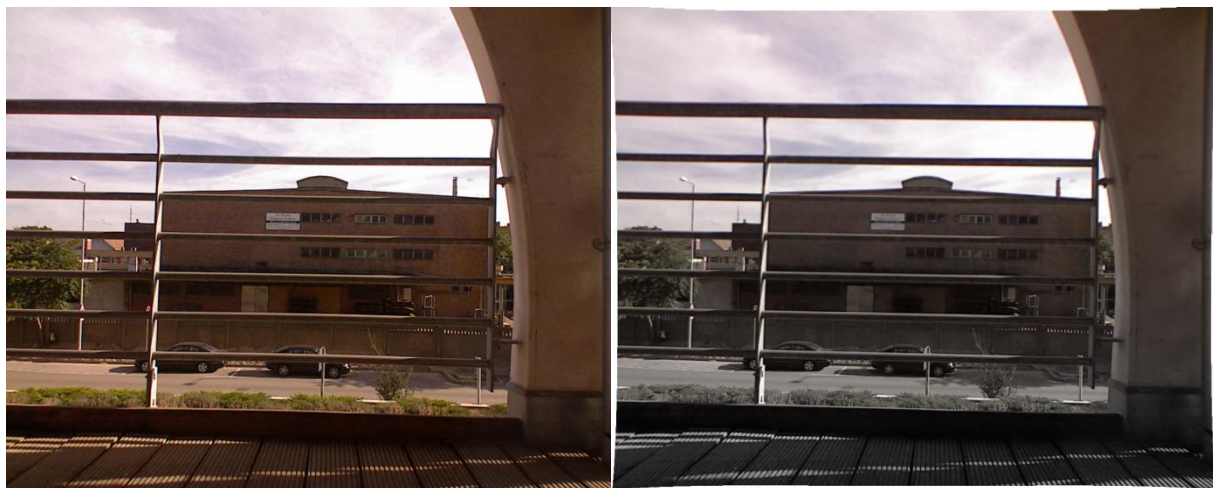
23. ábra A torzítás korrigálása: a) eredeti (torz) kép, b) torzításkorrigált kép - a kép felső része a programom által végzett korrekciót, még az alsó része a MATLAB CCT eredményeit mutatja, amelyek a várakozásnak megfelelően fedésben vannak
