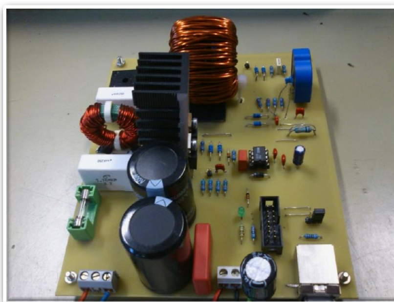
4.9. ábra: Az elkészült panel az alkatrészek beforrasztása után
