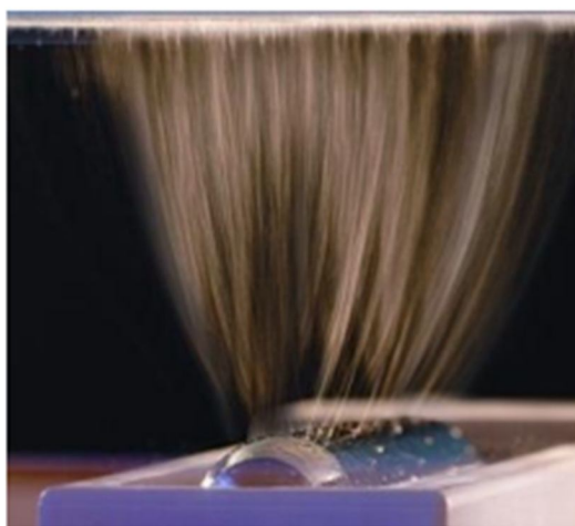
7. ábra A Nanospider működés közben, jól láthatóak a szálak és a szálképzéshez használt forgódob
