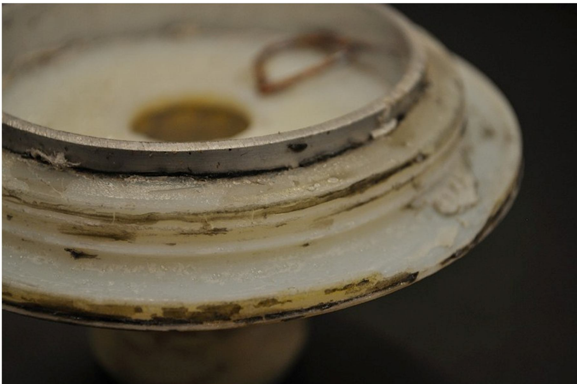
17. ábra Polimer fej tönkremenetelének kezdeti fázisa
