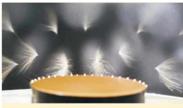
13. ábra Szálképzés folyékony polimerrel töltött tálból
