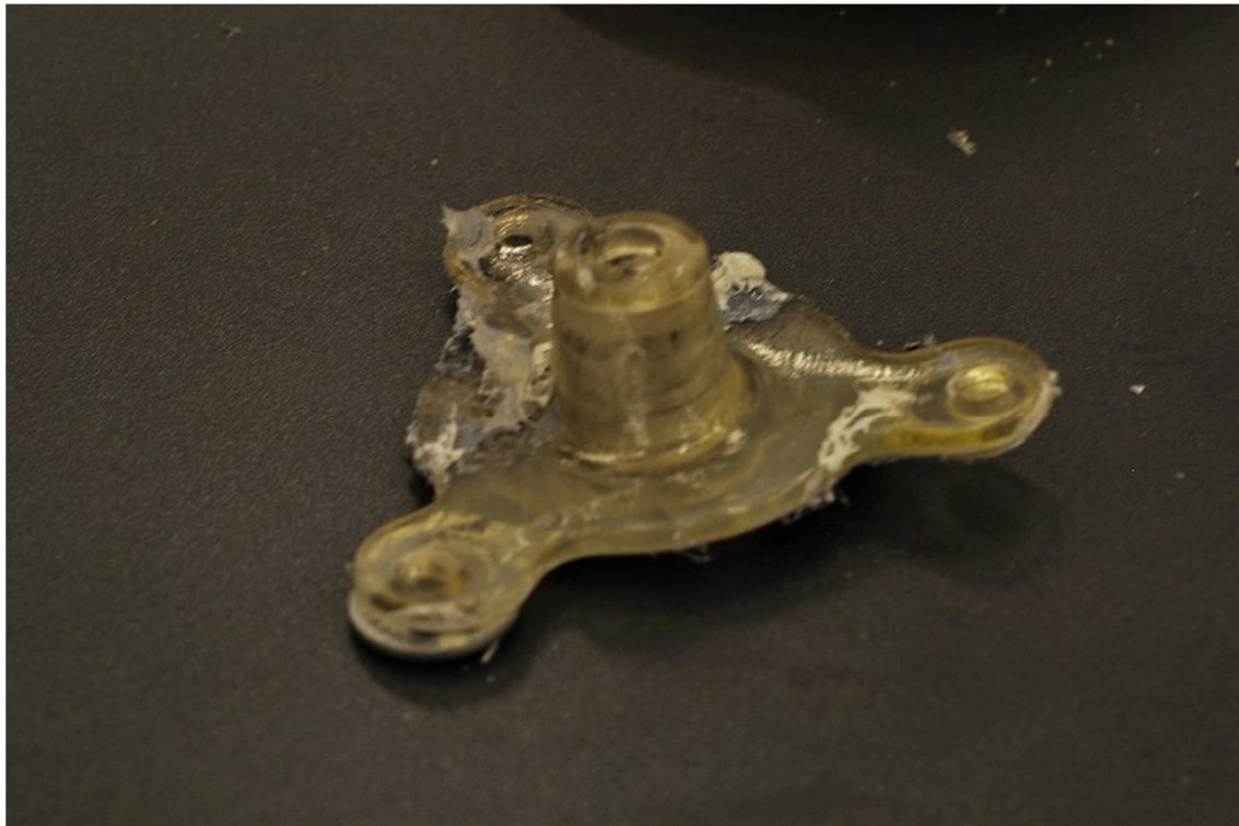
19. ábra A deformálódott alaplap
