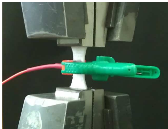
15. ábra Az akusztikus emissziós mérés elrendezése
