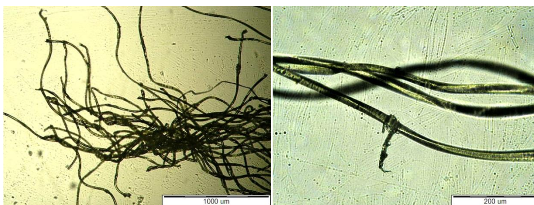
28. ábra Elszakadt fonal mikroszkópos képei 5 és 20-szoros nagyításban
