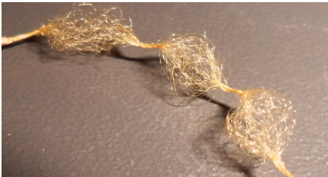
29. ábra A szakítóerővel megerhelt fonal szerkezete
