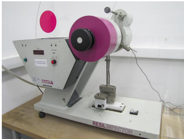
11. ábra: Ceast Resil Impactor Junior típusú számítógép vezérlésű ütőmű DAS 8000 adatgyűjtővel [14]
