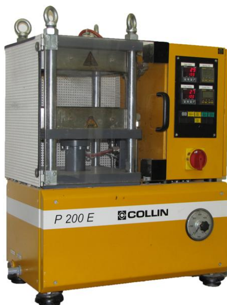
9. ábra: Collin Teach-Line Platen Press 200E típusú laborprés [14]
