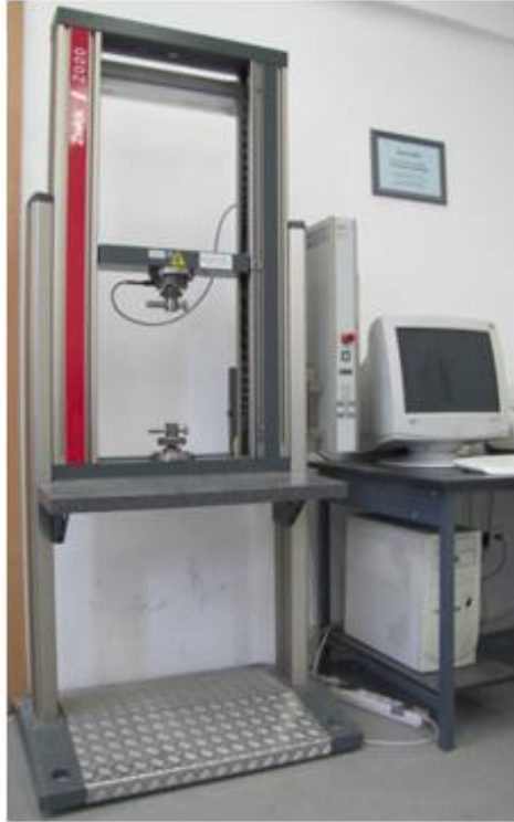
12. ábra: Zwick Z020 típusú univerzális szakítógép [14]
