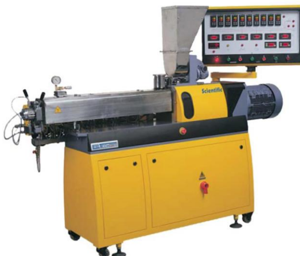
7. ábra: Labtech scientific moduláris ikercsigás extruder [14]
