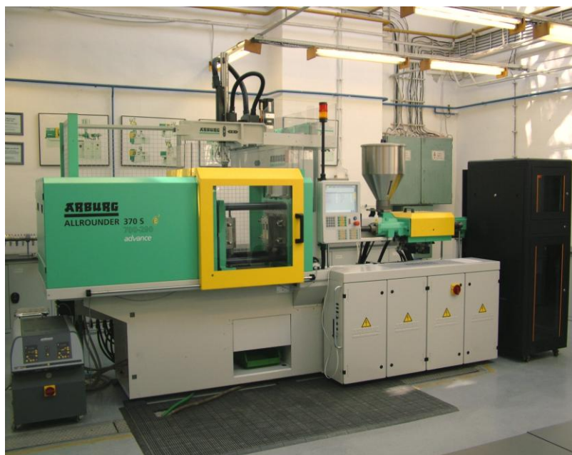
10. ábra: Arburg Allrounder Advance 370S 700-290 típusú fröccsöntő berendezés [14]
