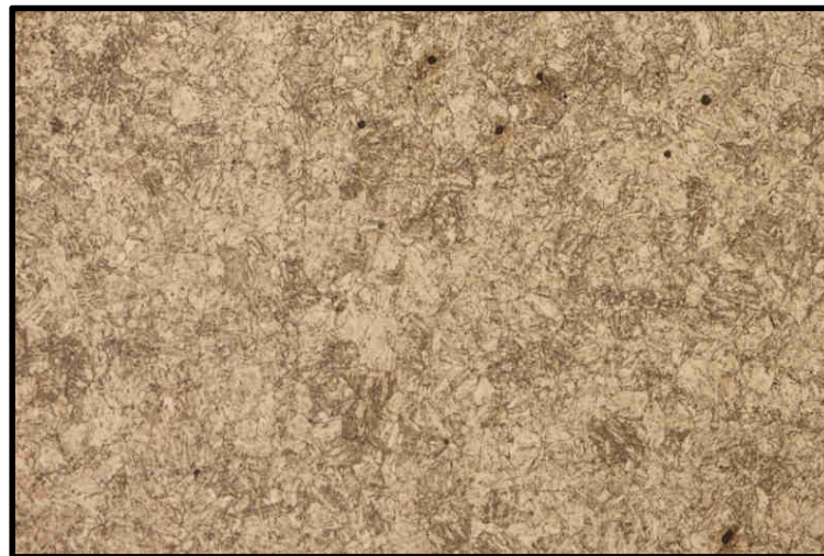
5. ábra: Nemesített, nagyszilárdságú (S690QL) acél szövetképe (Marószér: 2% HNO_3 , Nagyítás 200x)
