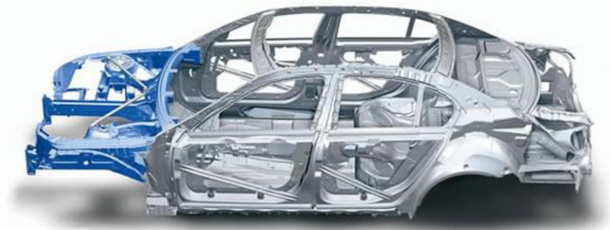
1. ábra Személygépjármű vázának alumínium ötvözetből készült elemei
