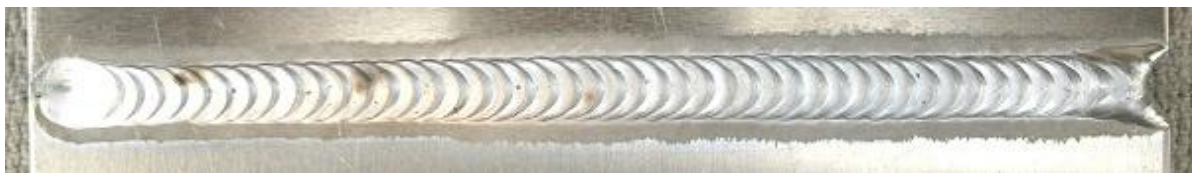
11. ábra Korona oldal (3.1.-es próbadarab)
