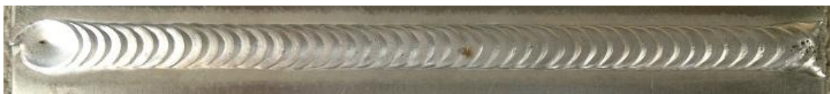
12. ábra Korona oldal (3.2.-es próbadarab)
