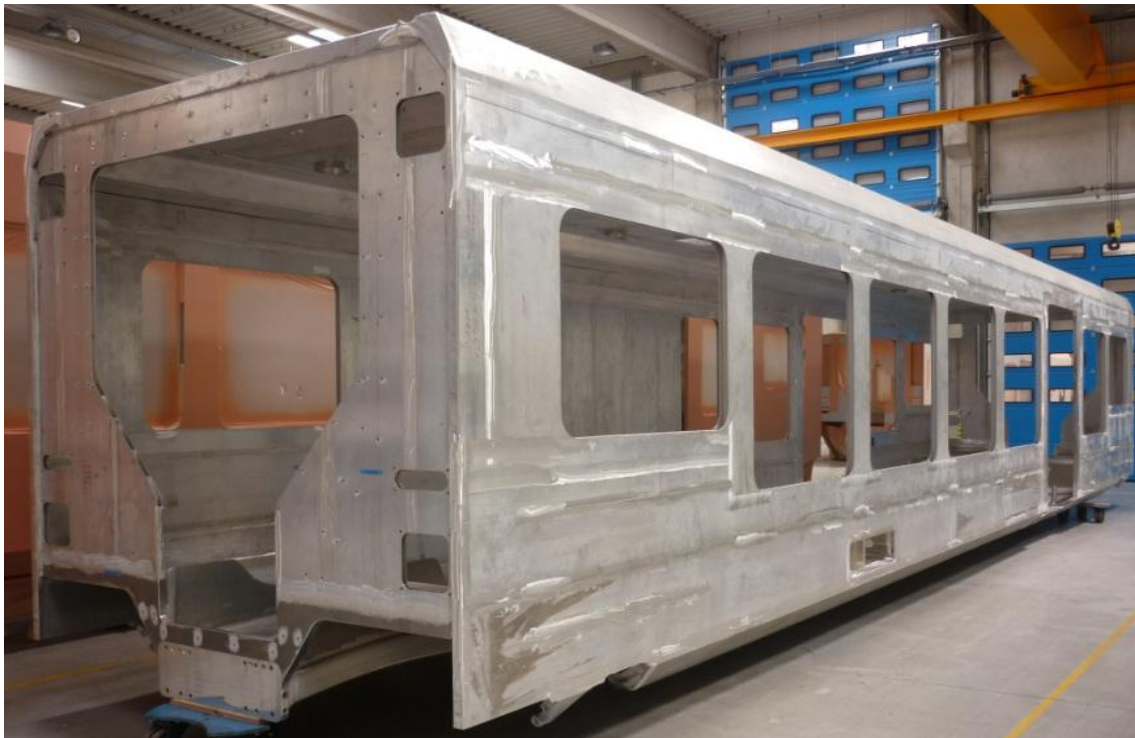
3. ábra Készre hegesztett kocsiszekrény [1] [7]
