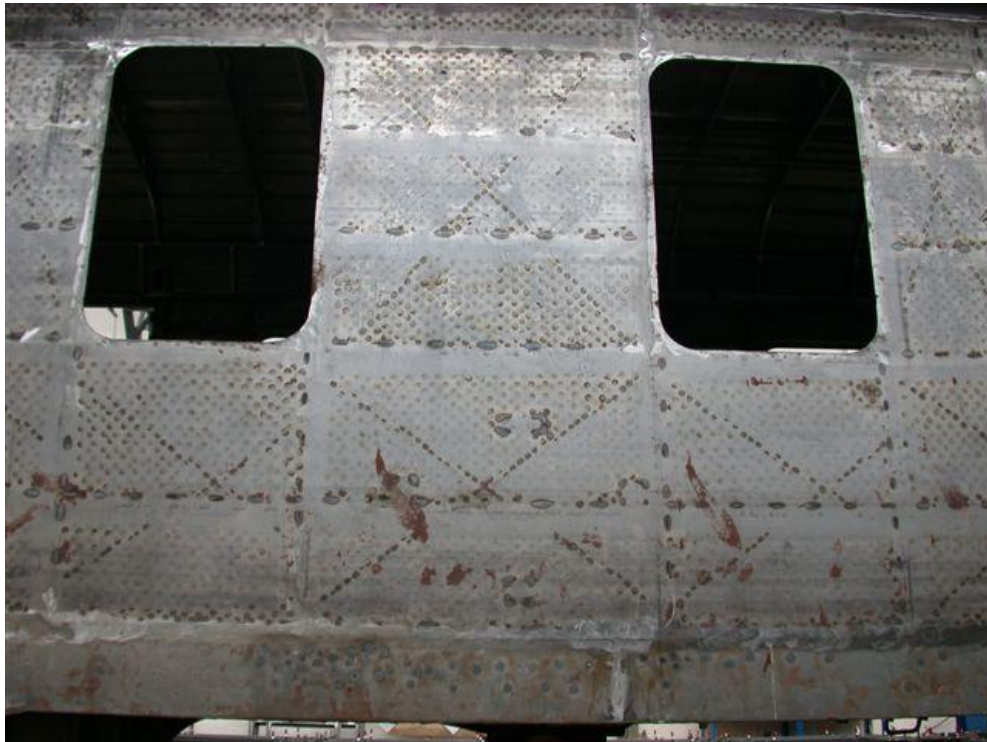
2. ábra Termikus ráfeszítéssel készített kocsi oldalfala [1] [7]
