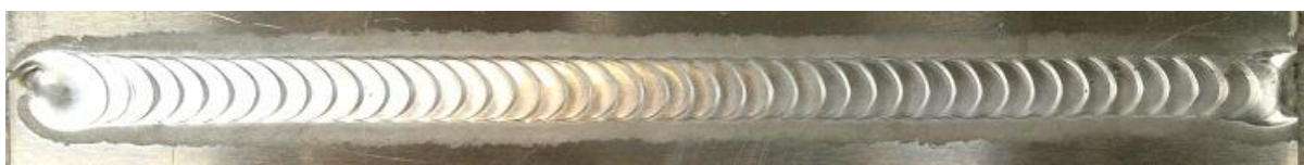
14. ábra Korona oldal (10.-es próbadarab)
