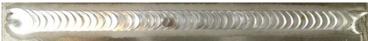
13. ábra Korona oldal (9.-es próbadarab)
