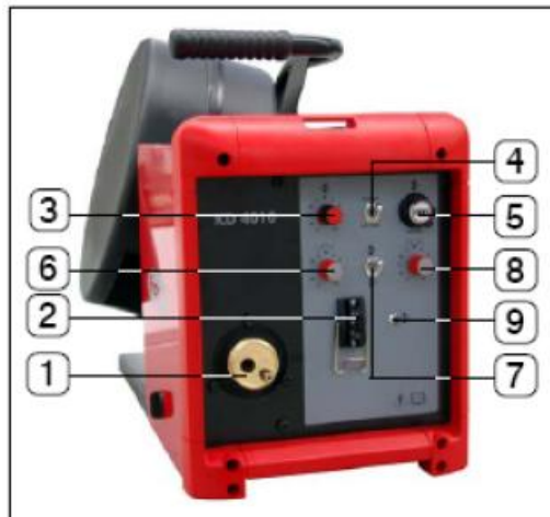
8. ábra Hideghuzalos előtoló berendezés [6]
