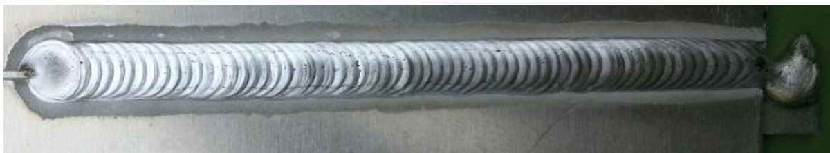
16. ábra Korona oldal (19.-es próbadarab)
