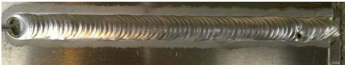
15. ábra Korona oldal (18.-es próbadarab)
