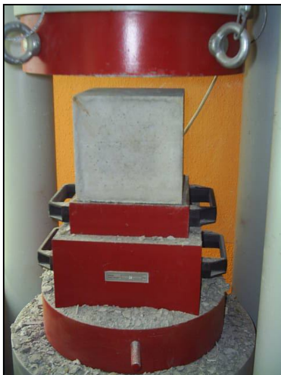
19. ábra: Próbakocka a terhelés előtt
