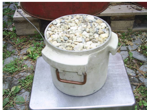
12. ábra: Halmazsűrűség-vizsgálat (száraz)
