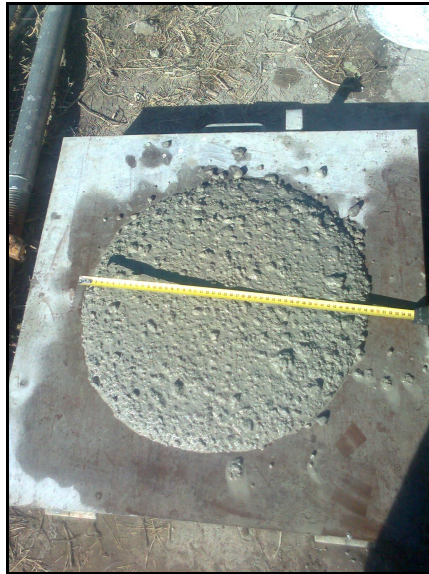
16. ábra: Terület mérés a módosított receptúra szerinti betonkeveréken
