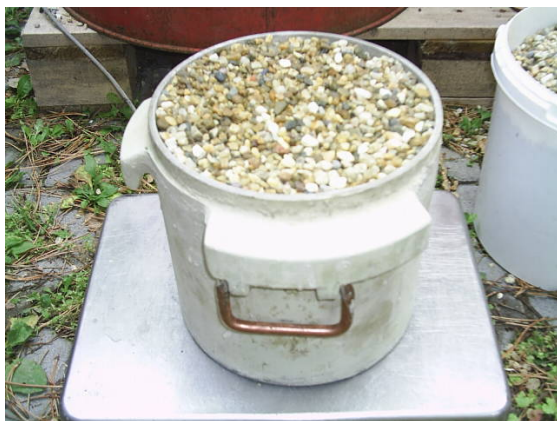
11. ábra: Halmazsűrűség-vizsgálat (nedves)
