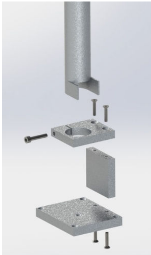
9. ábra: Ejtőtároló felépítése
