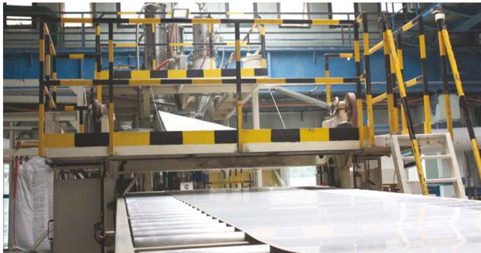
16. ábra. Levegőn történő hűtés görgős továbbítókkal
