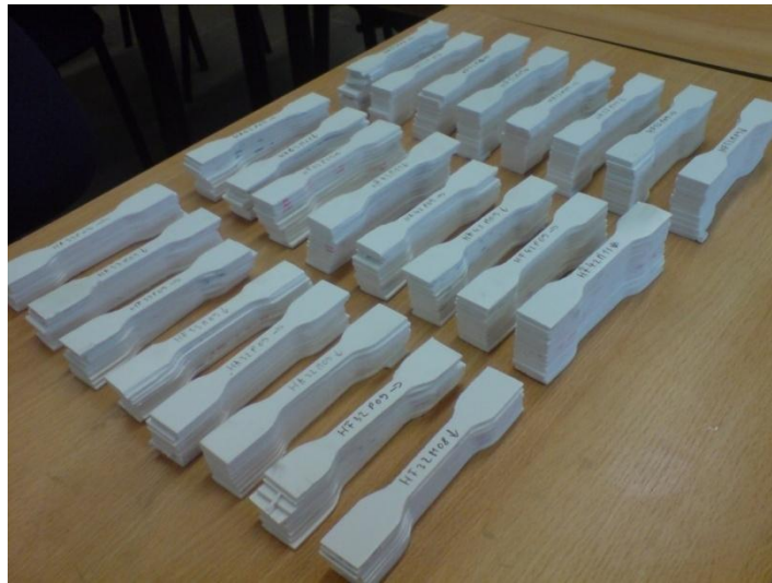
24. ábra. A vizsgált habos próbatestek a vizsgálat előtt (összesen 240 db)
