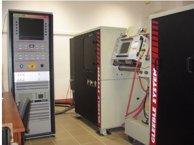
16. ábra - A Gleeble 3500 termo-mechanikus szimulátor a Miskolci Egyetem Mechanikai Technológiai Tanszékén
