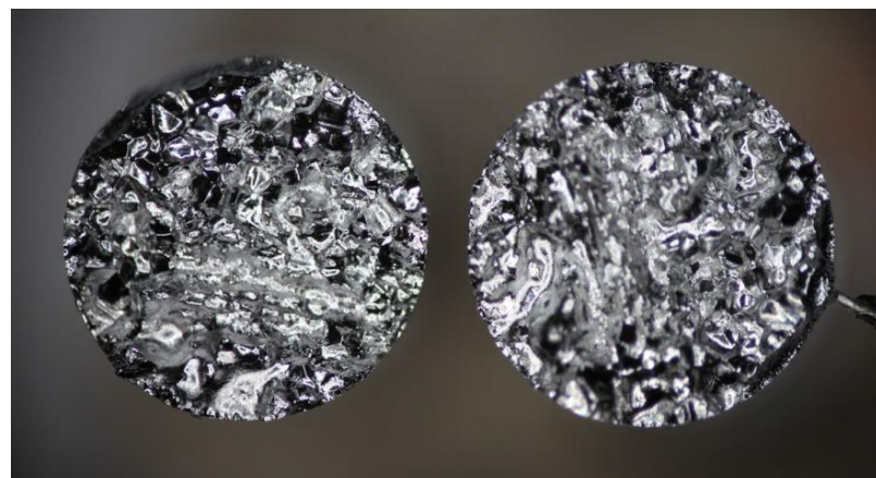
18. ábra - NST próbatest szakadási felülete, felülnézet
