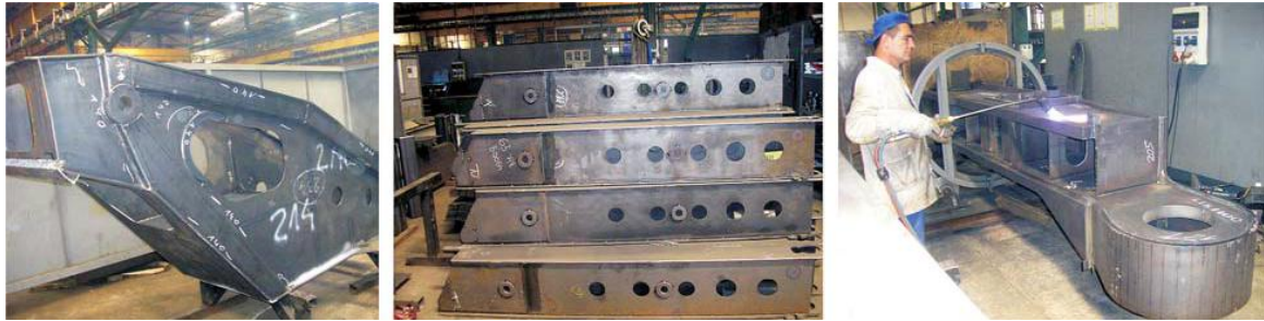
15. ábra - S960QL acélból készült hegesztett szerkezetek 16
