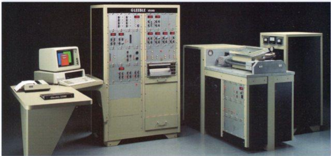
4. ábra - Gleeble 1500-as fizikai szimulátor az 1970-es évekből 6
