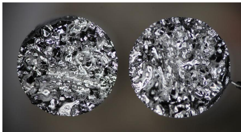
18. ábra - NST próbatest szakadási felülete, felülnézet
