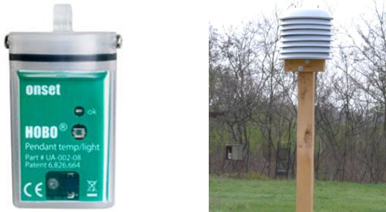
11. ábra. HOBO UA-002 hőmérsékleti adatgyűjtő és a mérések során használt árnyékoló
