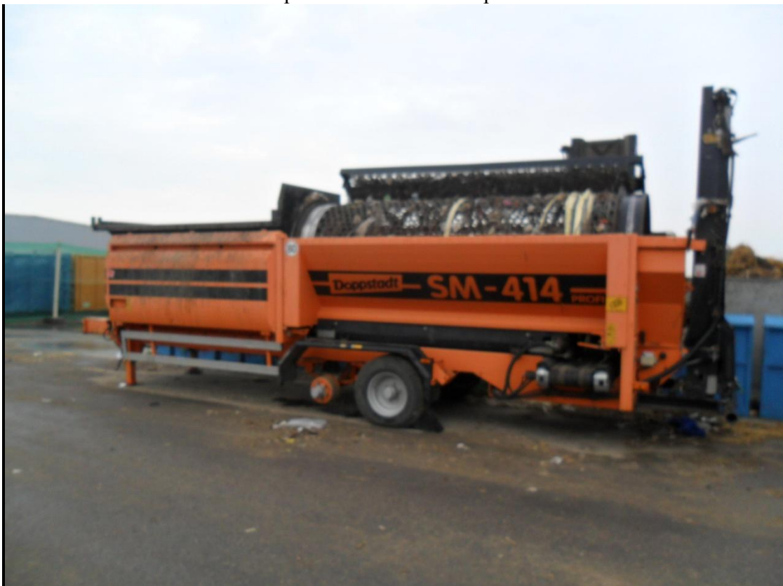
6. kép. Az alkalmazott dobrosta
