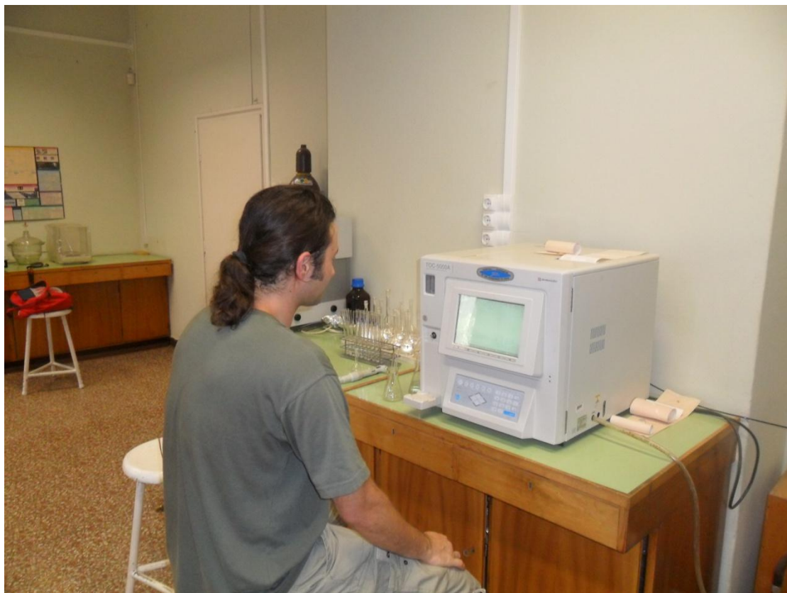
11. kép. TOC mérése vizes kivonatból
