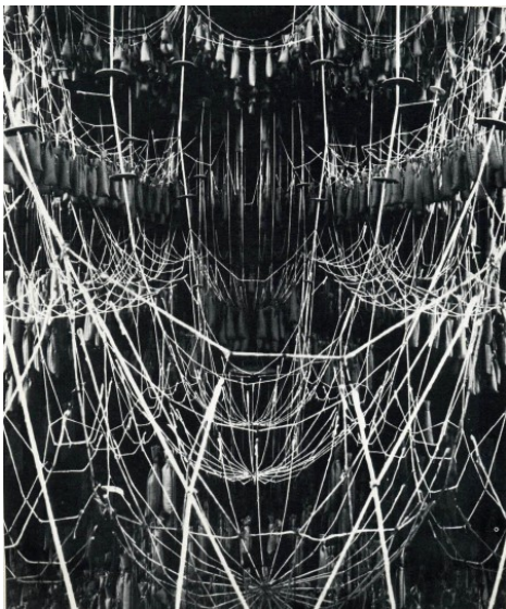
5. ábra: Antoni Gaudí: A Güell kolónia kápolnájának láncmodellje
