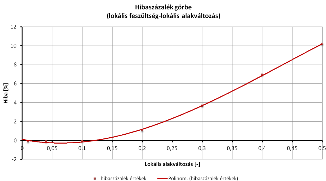
16. diagram. Lokális feszültség-lokális alakváltozás hibaszázalék görbéje
