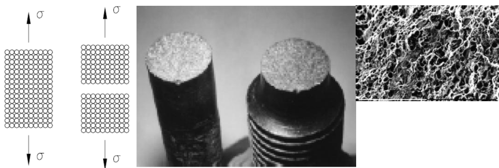
10. ábra. A rideg törés elméleti folyamata és a töret felület szemléltetése [9]
