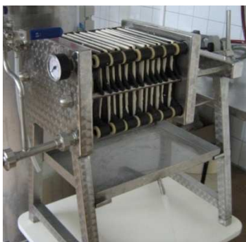
13. ábra: Keretes szűrőprés, nyitott állapotban
