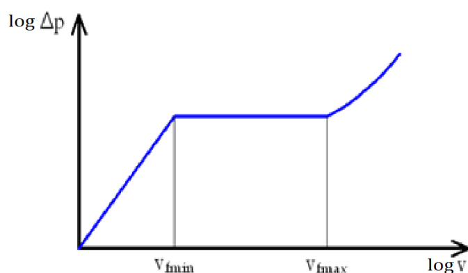
2.ábra. A nyomáskülönbség változása az üres keresztmetszetre vonatkoztatott gázsebesség függvényében.
