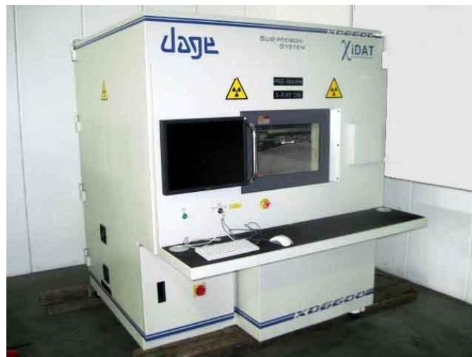
8. ábra: Dage Xidat XD6600 típusú röntgenmikroszkóp
