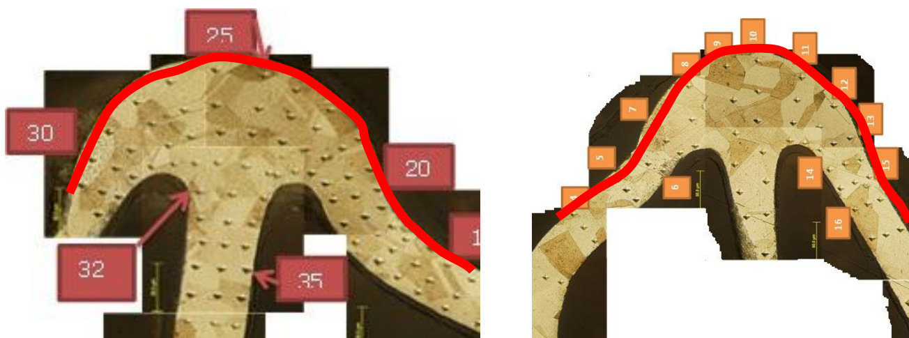
68. ábra: Külső szélső szál a patológiás (bal) és az eredeti (jobb) Taxus Express sztenten, pirossal jelölve
