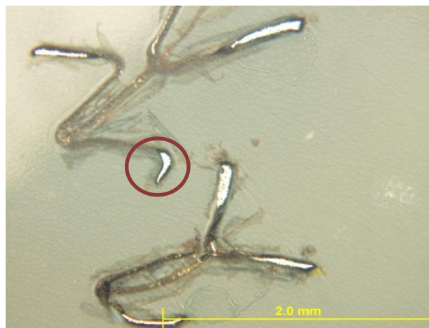
53. ábra : A szemcseszerkezet vizsgálat eredményeinek ismertetése az eredeti Taxus Express sztent esetén
