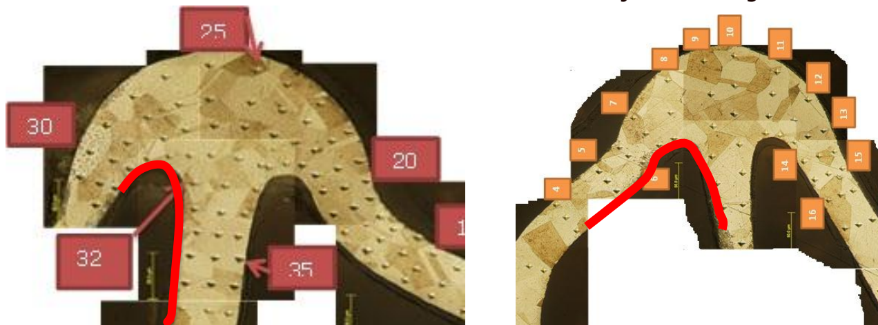
66. ábra: I. belső szélső szál a patológiás (bal) és az eredeti (jobb) Taxus Express sztenten, pirossal jelölve
