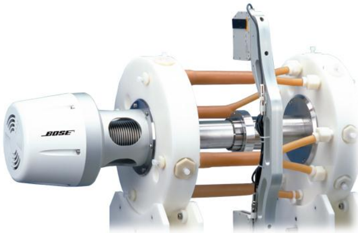
28. ábra: A BOSE cég sztentfárasztásra alkalmas berendezése (10)
