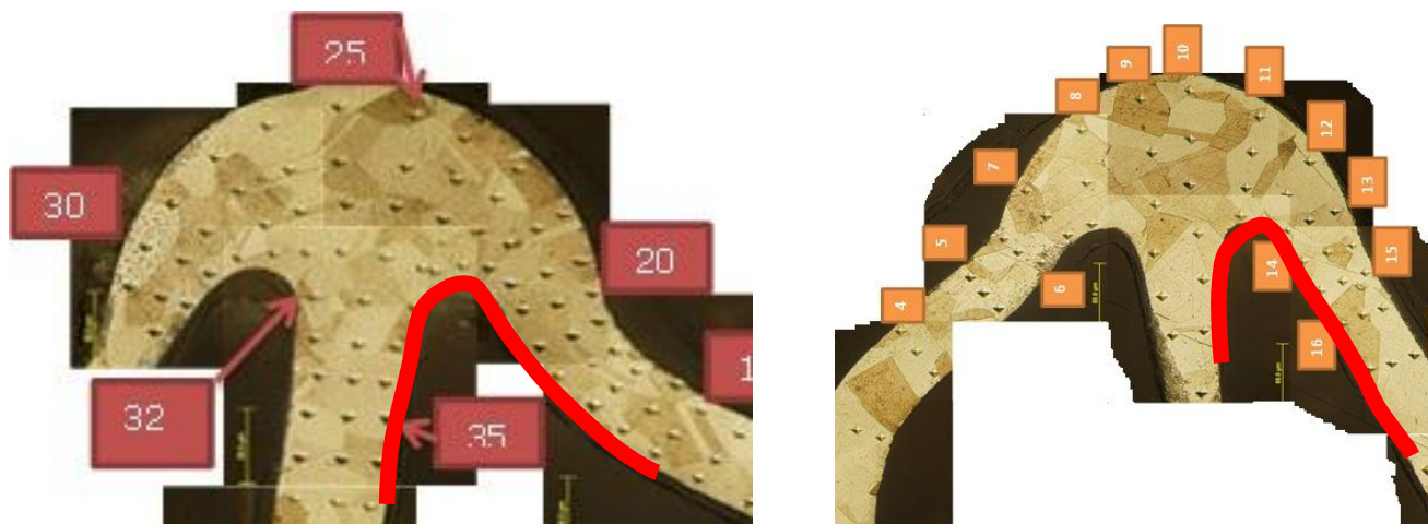
67. ábra: II. belső szélső szál a patológiás (bal) és az eredeti (jobb) Taxus Express sztenten, pirossal jelölve
