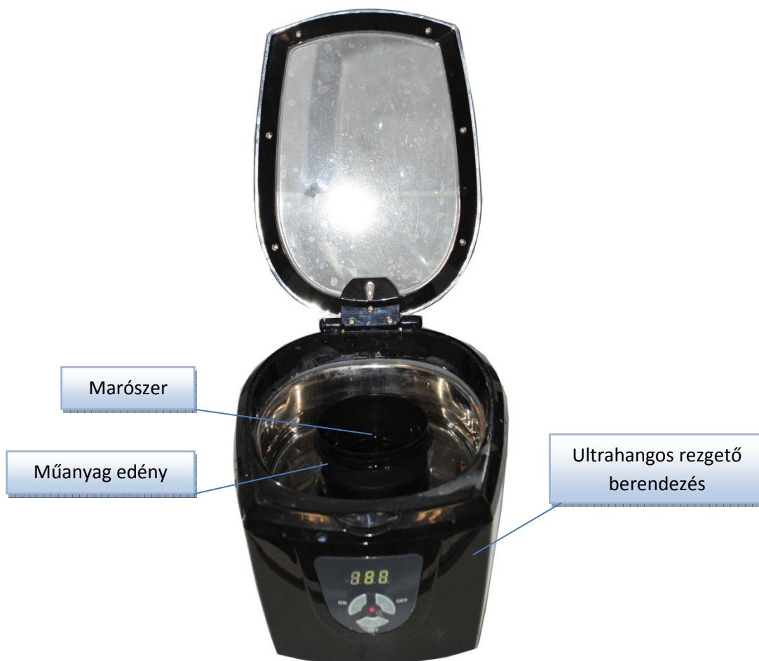
9. ábra. A kémiai maratáshoz használt berendezés összeállítása
