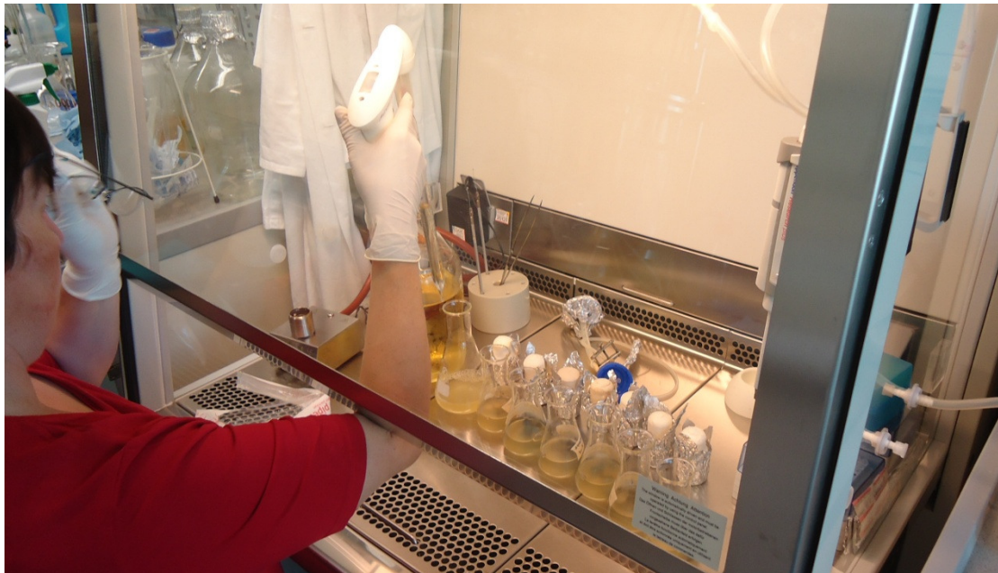
27. ábra. A bacillus sphaericus baktériumkultúra hozzáadása a folyékony médiumot és a mintákat tartalmazó EllenMeyer-lombikokhoz
