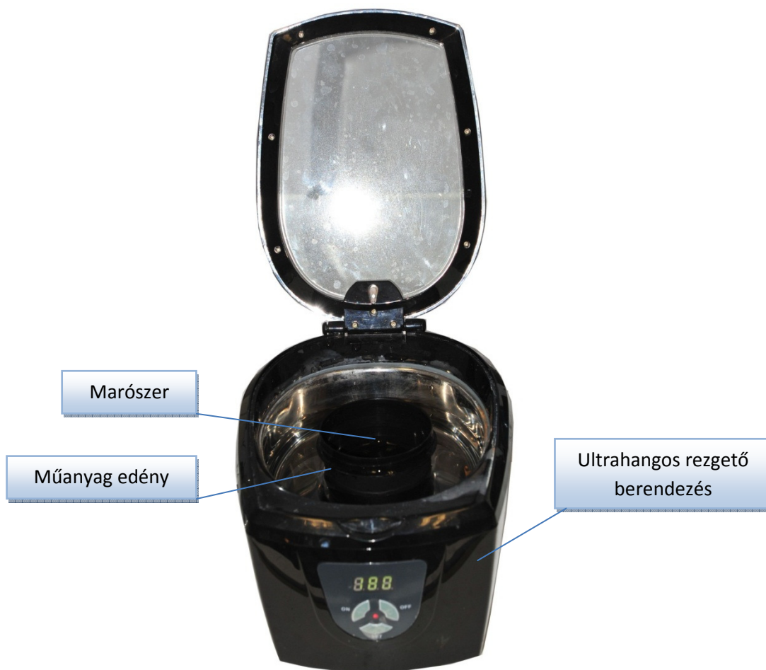
9. ábra. A kémiai maratáshoz használt berendezés összeállítása
