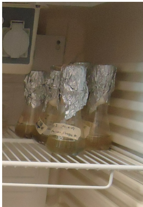
30. ábra. Bacillus sphaericus baktériummal "fertőzött" minták a 37 °C-os szekrényben
