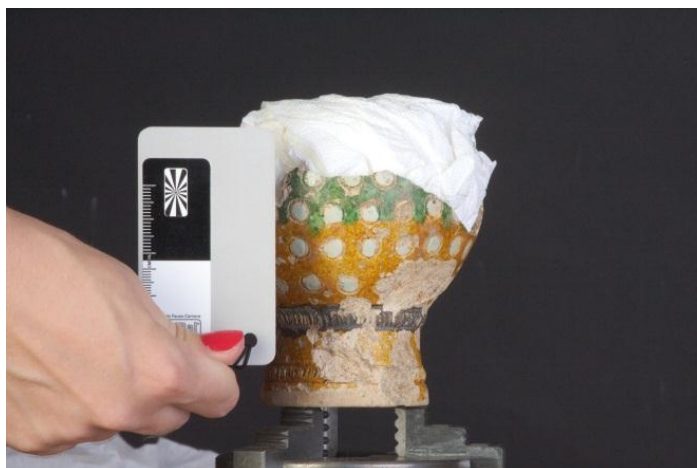
4.14. ábra Az abszolút szürkét megjelenítő színekártya (képkorrekciókhoz szükséges)
