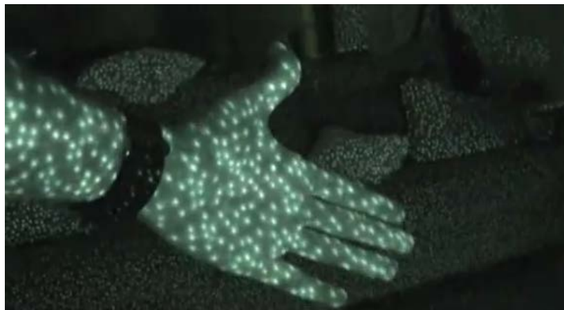
12. ábra - A Kinect által kibocsátott sűrű pontthalmaz 81 [10]
