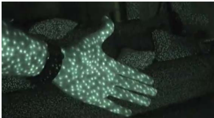
12. ábra - A Kinect által kibocsátott sűrű ponthalmaz [10]
