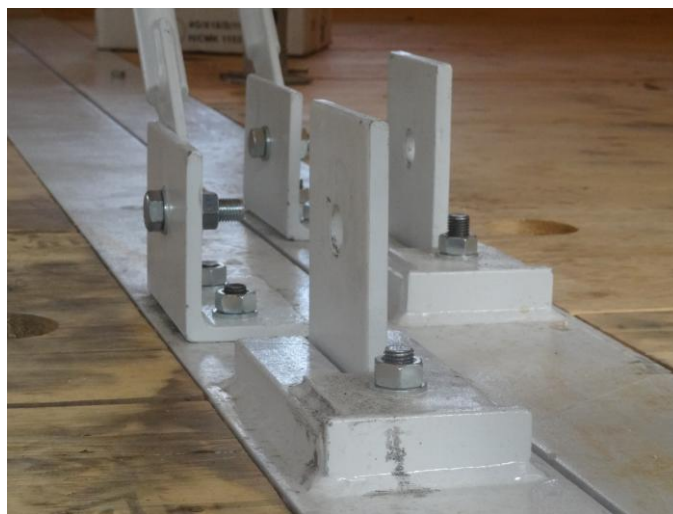
35. ábra: Az összerakott emelési pont, háttérben az ideiglenes merevítéssel
