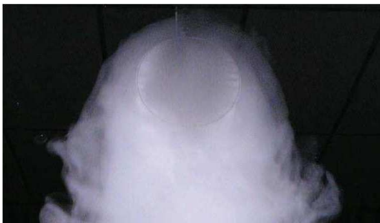
4.2. ábra, áteresztő anyagú szövet légcsatorna, KE Fibertec
