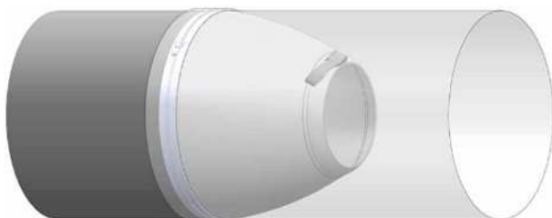
1.4. ábra: Fojtó elem a textil légcsatornában [26].
