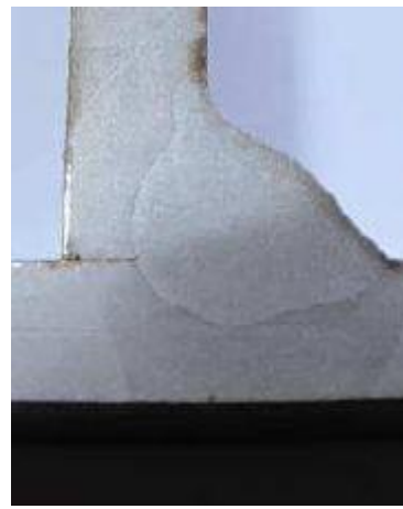
3.3. ábra Lágyságú, széles ívvel készült varrat; Dinamika -50%
