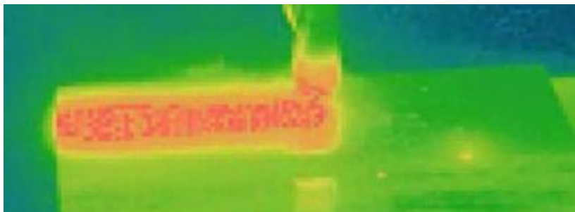
3.6. ábra Az 1D1 munkadarab hegesztés közbeni hőképe
