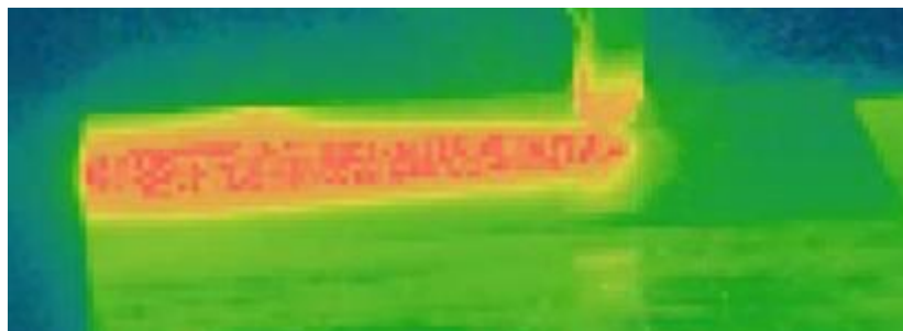
3.10. ábra A 2A1 munkadarab hegesztési közbeni hőképe
