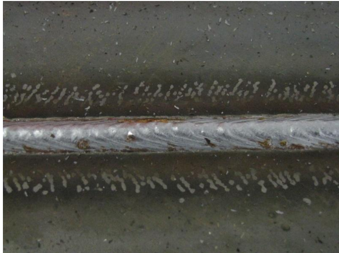
1.3. ábra Duo Pulse eljárással készült varrat
