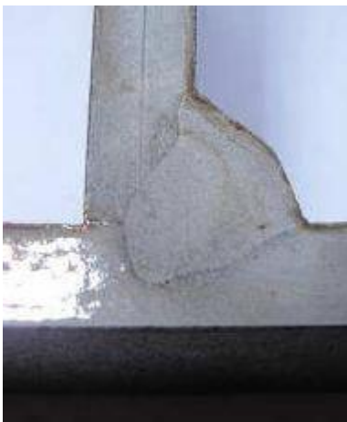
3.2. ábra Kemény, keskeny ívvel készült varrat; Dinamika +50%
