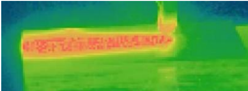
3.26. ábra A 2A1 munkadarab hegesztési közbeni hőképe
