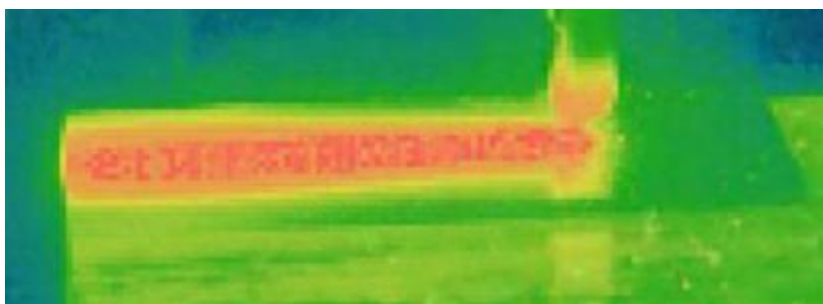
3.22. ábra Az 3F1 munkadarab hegesztés közbeni
