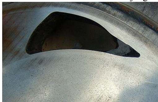
7.kép - A kipufogóníylás lerakódásai
