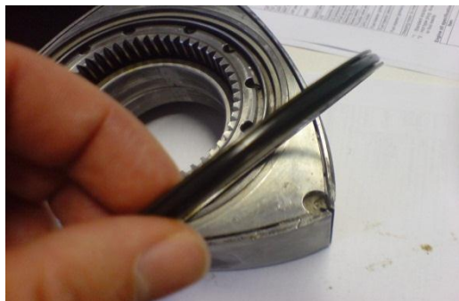
9.kép - Jó állapotú gumigyűrű
