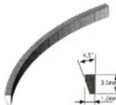
10.ábra - Rx8 Renesis motor oldaltömítése
