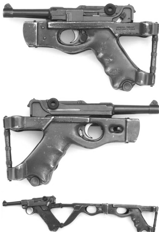
11. kép Benke-Thiemann-féle behajtható válltámasz P08 öntöltő pisztolyon 26
