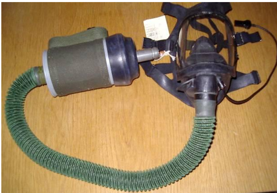
1.10 – M25A1 álarc, kívülről, bordástömlőn keresztül csatlakoztatott nagyméretű szűrőbetéttel 10
