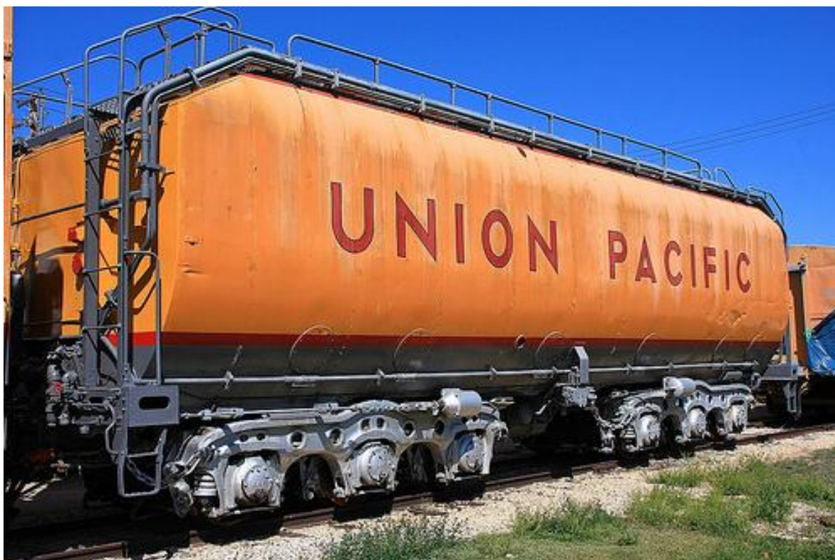
Egy harmadik generációs UP gázturbinás hattengelyes szerkocsija
