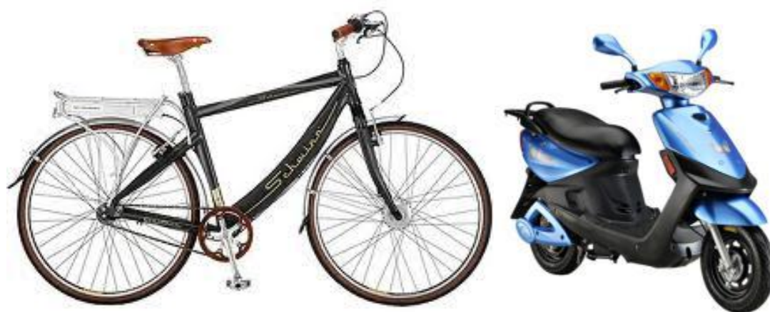
Balra fent: Schwinn elektromos segédhajtású kerékpár. Elektromos módban 25 km-t tud megtenni, 40 km tekeréssel vagy konnektorról feltölthető. Jobbra fent: Keyword elektromos robogó. A jármű maximális sebessége 45 km/h, az 1,2 kW-os motorral 80 km-t tud megtenni egy feltöltéssel.
