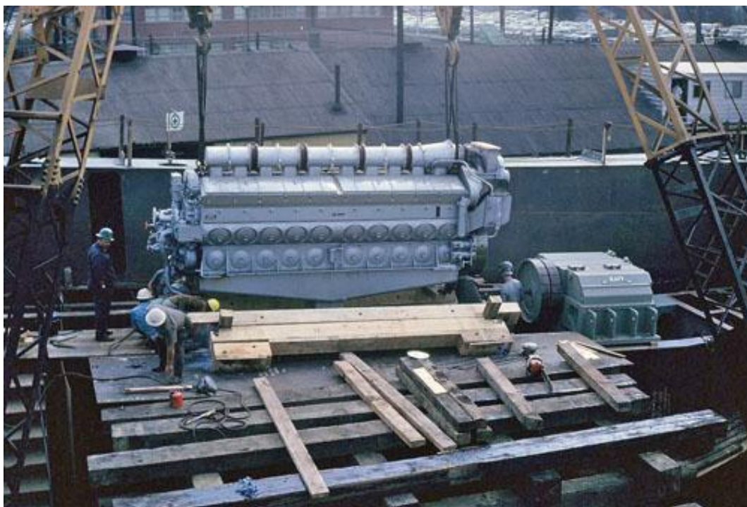
Egy húszhengeres GM-EMD 20-710-G3-as dízelmotor, jelenleg a legerősebb, vasúton használt ilyen egység. Teljesítménye 5000 lóerő, lökettérfogata 232 000 cm 3 .
