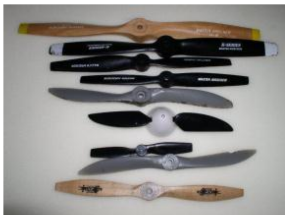
Különböző, repülőgépmodelleknél használt fa- és műanyag propellerek (fent) és egy propeller szelvénykeresztmetszetei a hossza mentén (lent)
