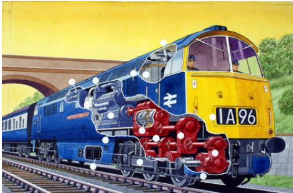
Fent: Egy brit dízel-hidraulikus mozdony metszeti-nézeti ábrája. Jól látszik, ahogy a dízelmotor csatlakozik az örvényszivattyúhoz, amely a forgási energiát a háromtengelyes forgóváz mindhárom tengelyére továbbítja a hajtóművön keresztül (piros) Lent: MÁV M41-es sorozatú dízel-hidrodinamikus meghajtású "Csörgő". A mozdony minden nem villamosított fővonalon teljesít szolgálatot, teljesítménye 1800 LE
