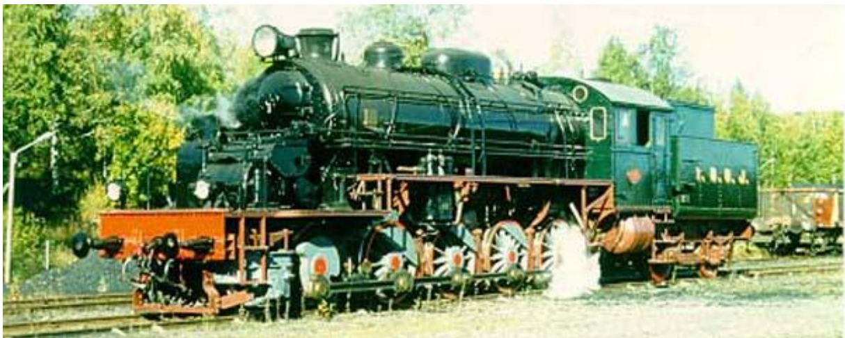
Ljungström első, 1800 LE-s gőzturbinása 1921-ből (fent) és a NoHAB-nál készült, ma is működőképes példány (lent)
