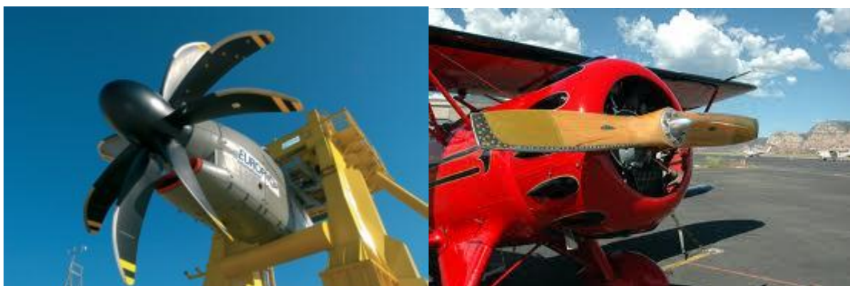
Fából készült, nem állítható propeller egy régi kétfedelűn (balra), és változtatható állásszögű légcavar tesztelés közben, vitorlázóállásban (jobbra)
