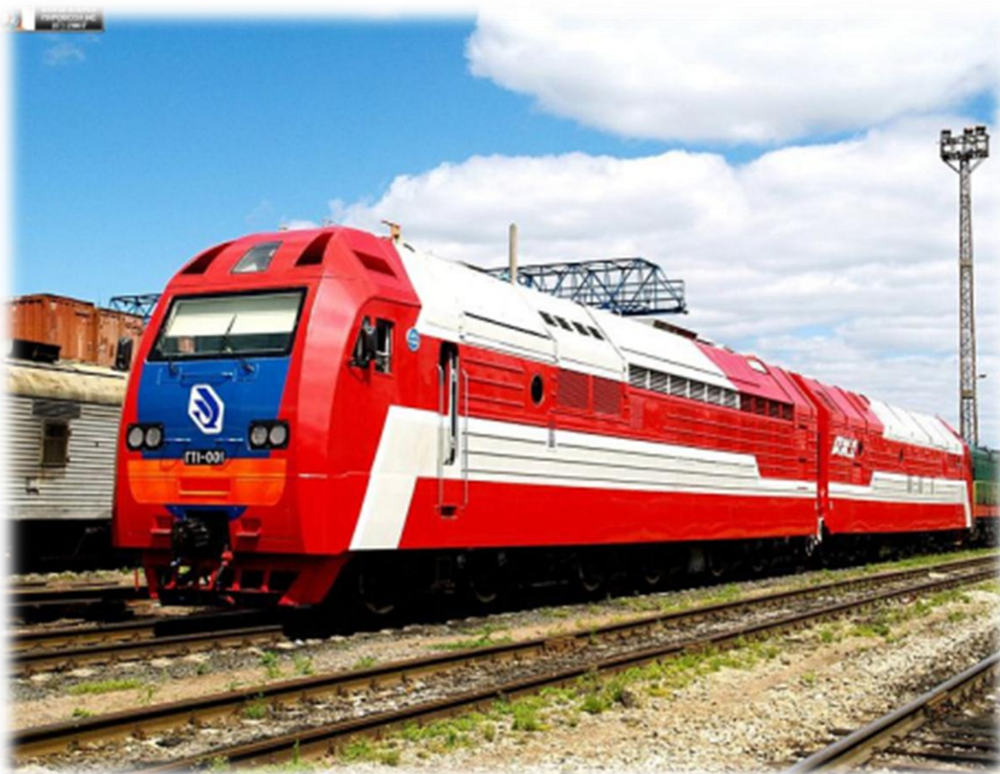
A 11 ezer lóerős, kétszekciós, LNG-tüzelésű GT1-001-es tehermozdony
