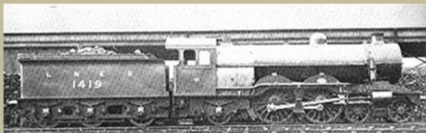
Egy szerkocsi kéttengelyes hajtott forgóváza (fent) és egy LNER 4-4-2 "Atlantic" gőzös, amelynek első futótengelyei segédgőzgéppel voltak ellátva
