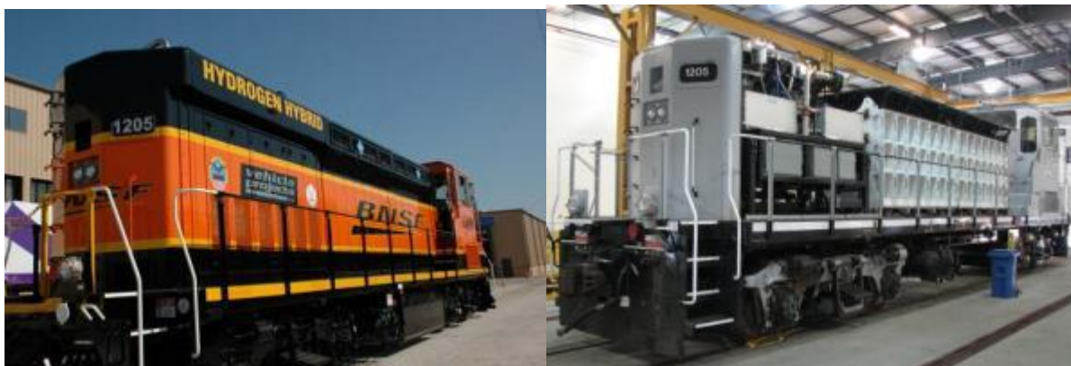
A BNSF Hydrogen Hybrid mozdony (balra fent) 2009-ben, illetve 2008 júliusában, építés közben (jobbra fent). Hozzánk legközelebb foglal helyet az üzemanyagcella, mögötte az akkumulátorok. Lent: a mozdony gépészeti elrendezése
