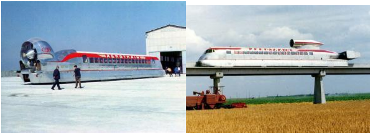
Aérotrain I-80 légsavarral (balra) és az átalakított HV-változat sugárhajtóművel 1974-ben
