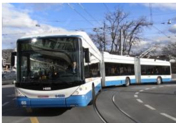
A 2012 őszen forgalomba állt 33 zürichi duplacsuklós önjáró troli egyike. A 24 méteres buszok 1,5 kilométert felsővezeték nélkül is képesek megtenni.
