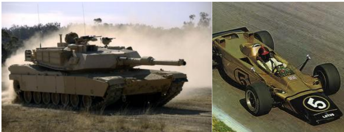
Balra: M1 Abrams nehéz harckocsi, jobbra: Lotus 56B, kísérleti gázturbinás Forma1-es autó teljesítménye kb. 700 LE, amivel máig a legjobb teljesítmény/tömeg arányú versenyautó
