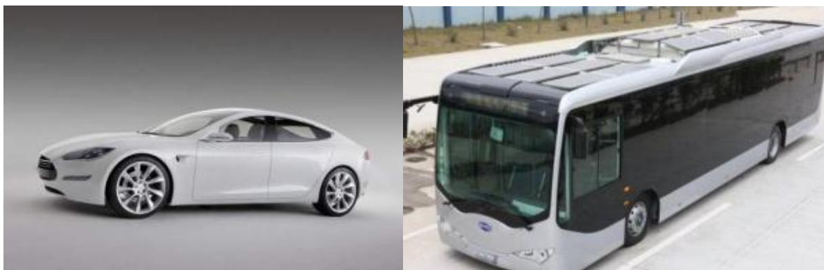
Balra fent: Tesla Model S 2012-ből. A 85 kWh-s Li-ion akkukkal felszerelt 420 LE-s (!!!) elektromos luxusautó akár 400 km-t is képes megtenni egyszerre. Jobbra fent: BYD elektromos autóbusz, hatótávja 100-120 km, ára 800 000 euró
