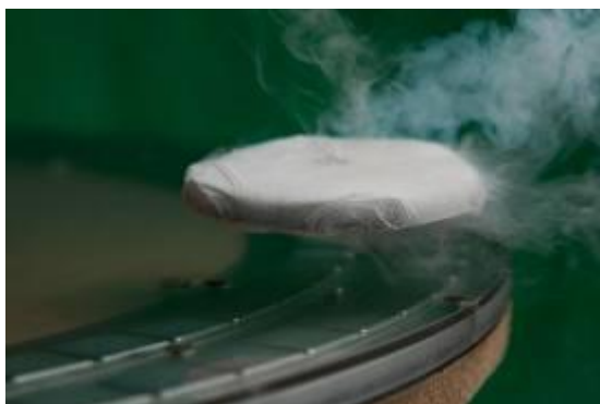
A -200\text{ }^{\circ}\text{C} -ra hűtött szupravezető energia-befektetés nélkül lebeg a mágnespálya felett (Meissner-effektus)
