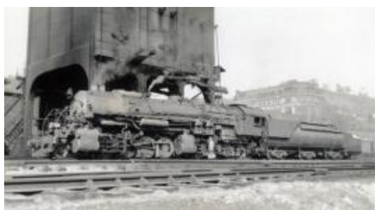
Fent: a még nagyobb 2-8-8-4 Virginian Triplex mozdony. Lent: a 2-8-8-0-s csuklós (balra) és a 2-8-0-s szimpla gőzmozdony, amelyeket 1920-ban az óriási gőzös „feldarabolásával” építettek meg
