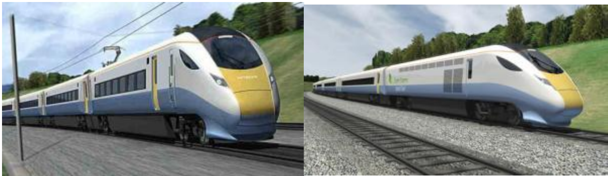
Számítógépes elképzelés a Hitachi SuperExpressről amelynek egyik fele dízelmotorral (jobbra) a másik elektromos felsővezetékkel (balra) tud haladni
