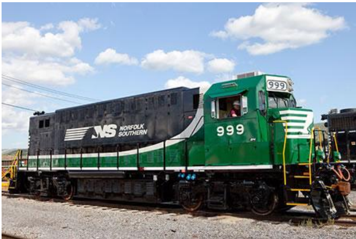
A világ első modern nagyvasúti akkumulátoros mozdonya, az 1500 lóerős NS999-es
