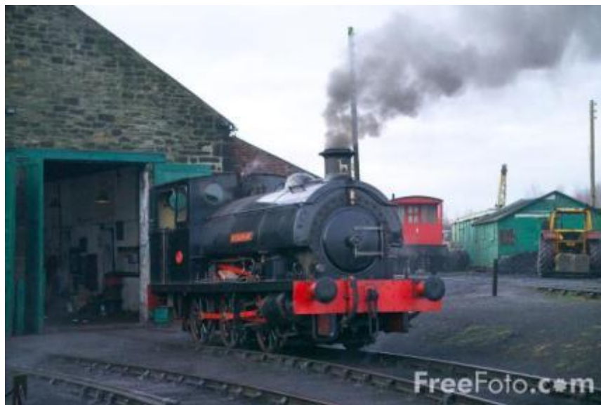
A Cristiani-féle gőzkompresszoros meghajtás működése (fent) és az egykoron átalakított 0-6-0-s, nyeregtagos (a szertartály a kazánon "ül") gőzmozdony napjainkban (lent)
