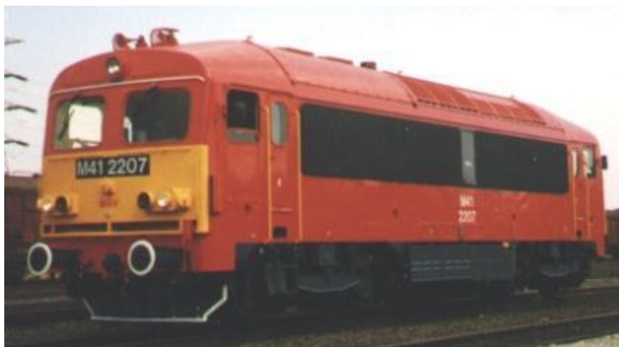
Fent: Egy brit dízel-hidraulikus mozdony metszeti-nézeti ábrája. Jól látszik, ahogy a dízelmotor csatlakozik az örvényszivattyúhoz, amely a forgási energiát a háromtengelyes forgóváz mindhárom tengelyére továbbítja a hajtóművön keresztül (piros) Lent: MÁV M41-es sorozatú dízel-hidrodinamikus meghajtású "Csörgő". A mozdony minden nem villamosított fővonalon teljesít szolgálatot, teljesítménye 1800 LE
