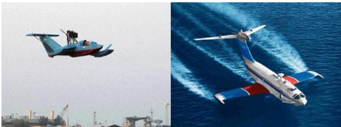
Balra: Bavar-2 repülőcsónak repülés közben. Jobbra: Szovjet Alexejev A-90 "Orlyonok" ("Sasocska") az egyik legsikeresebb ekranoplán. A gép farkán elhelyezett turbólégcsavaron kívül két gázturbinás sugárhajtómű szolgáltatja a hajtást, összteljesítményük kb. 15 000 LE volt
