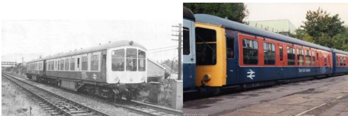
A BR BEMU (British Rail Battery-Electric Multiple Unit - Brit Vasutak Akkumulátoros Motorvonat) 1958-ban, és már Gemini-ként, átfestve 1990-ben
