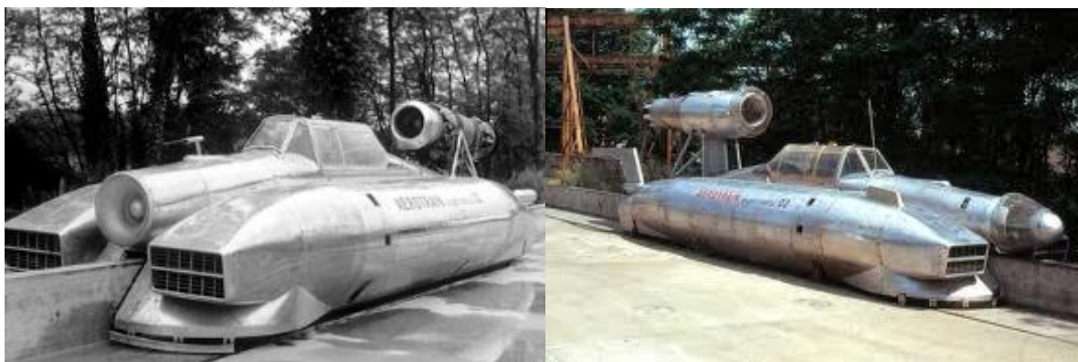
Az Aerotrain 02 sugárhajtóművel (balra) és rakétával (jobbra)
