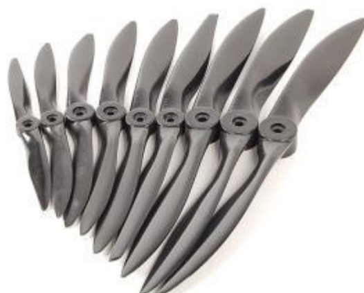
Különböző, repülőgépmodelleknél használt fa- és műanyag propellerek (fent) és egy propeller szelvénykeresztmetszetei a hossza mentén (lent)
