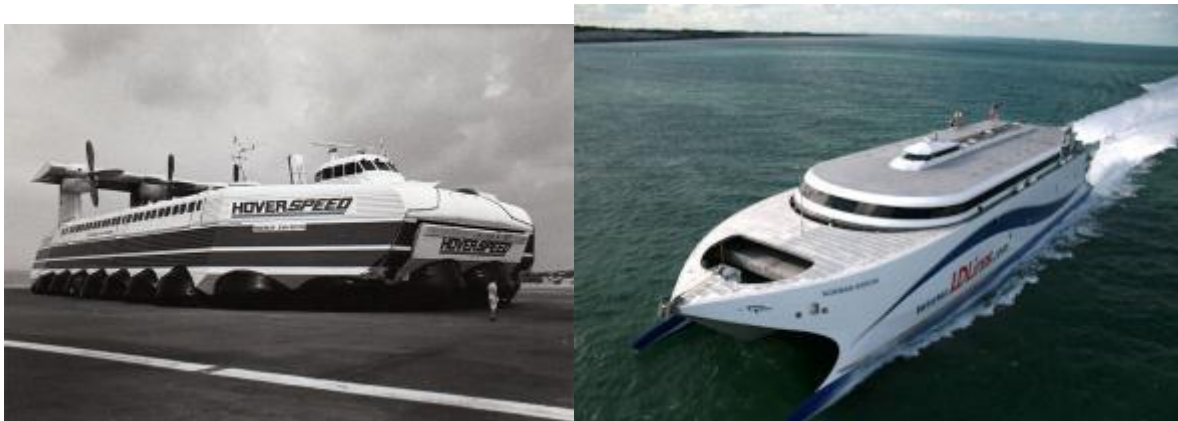
SEDAM NaviPlane-500 típusú légpárnás komp (balra). Végsebessége vízen 160 km/h, de ki tud jönni sík vízpartokra, mint a képen is látható. Norman Arrow, (jobbra) a világ legnagyobb személyszállító katamaránja. Hossza 112 méter, utazósebessége 39 csomó, azaz kb. 72 km/h. A hatalmas hajótestet 4 darab, összesen 50 000 LE teljesítményű MAN dízelmotor hajtja.
