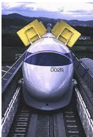
Balra: MLU-002-N nyitott fékszárnyakkal, jobbra: az SMLLMC vonat jellegrajza
