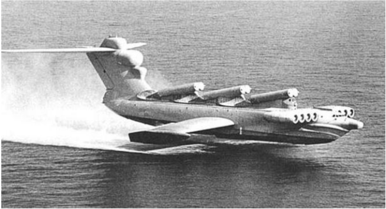
A Lun-osztályú ekranoplán a hátán 6 darab rakétával
