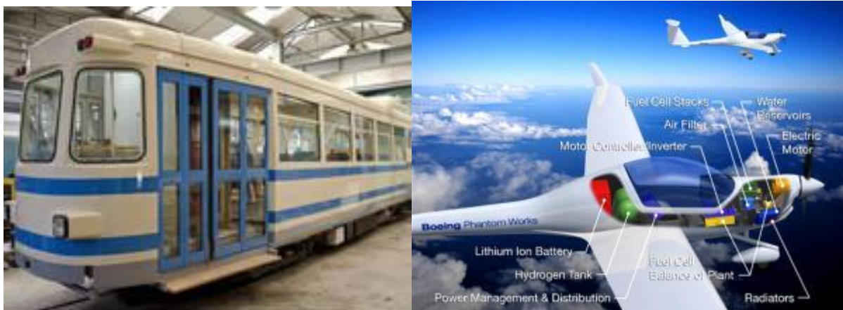
Balra fent: utólag üzemanyagcellássá alakított kísérleti villamos. Jobbra fent: A Boeing elképzelése az üzemanyagcellás repülőgépről. Balra lent: HDW Class-212-es üzemanyagcellás tengeralattjáró. Jobbra lent: HYDRA, a világ első tüzelőanyag-cellás hajója, 2003-ból. Teljesítménye 6,3 kW (8 LE).
