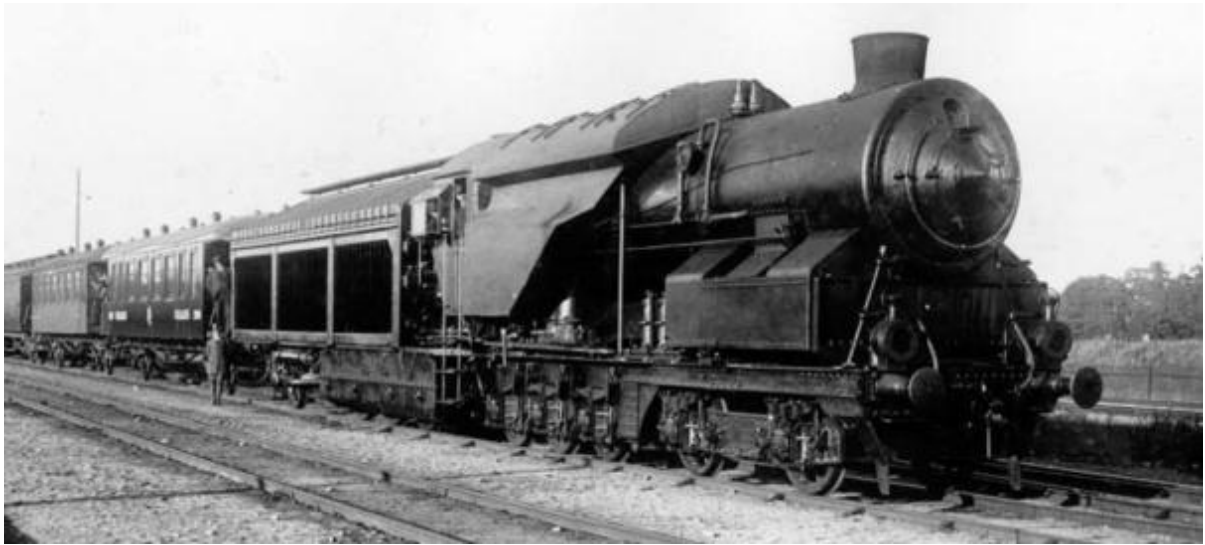
Ljungström első, 1800 LE-s gőzturbinása 1921-ből (fent) és a NoHAB-nál készült, ma is működőképes példány (lent)
