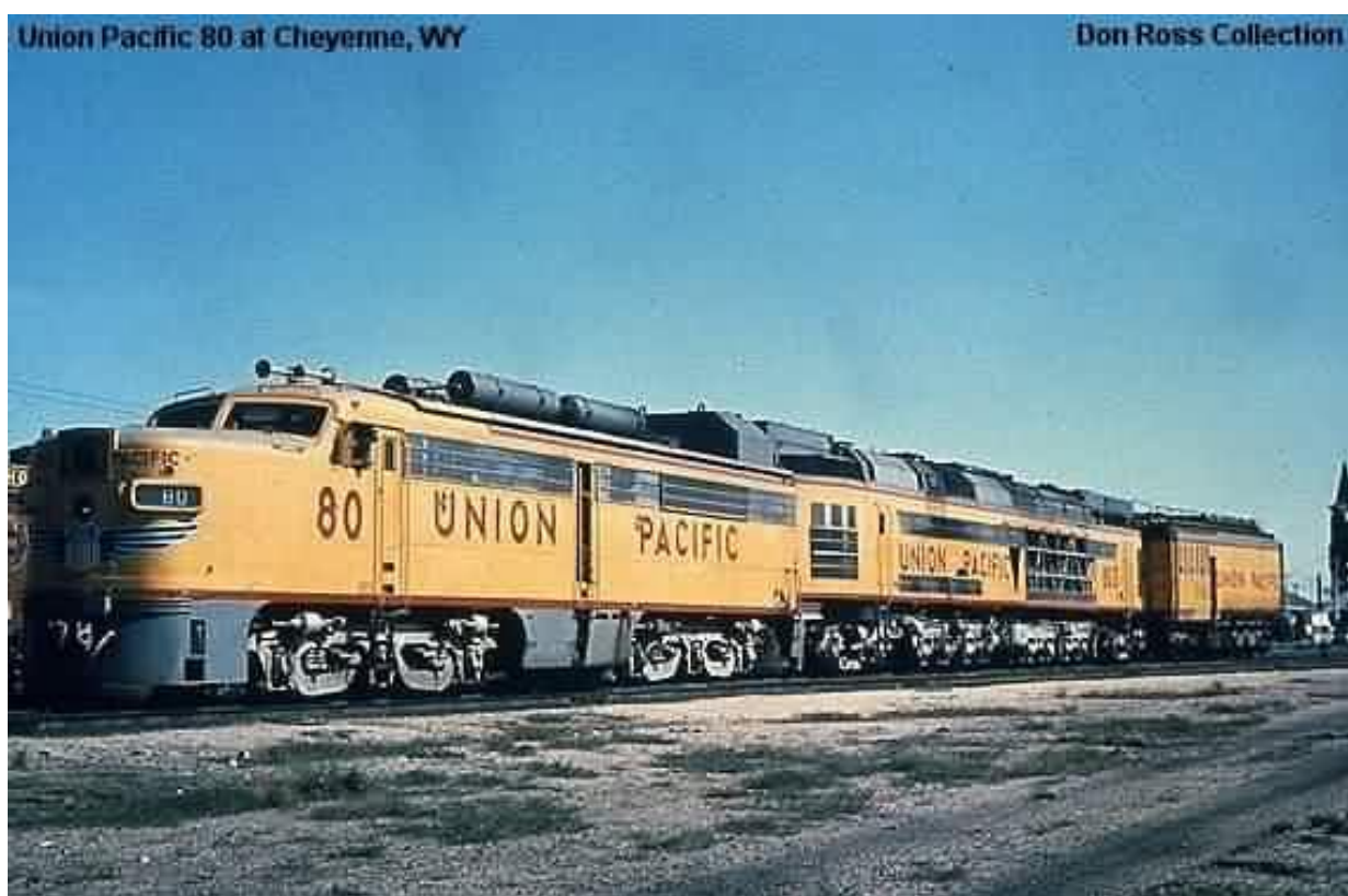
UP 8080-as pályaszámú, kétszekciós kísérleti szénportüzelésű gázturbinás mozdony
