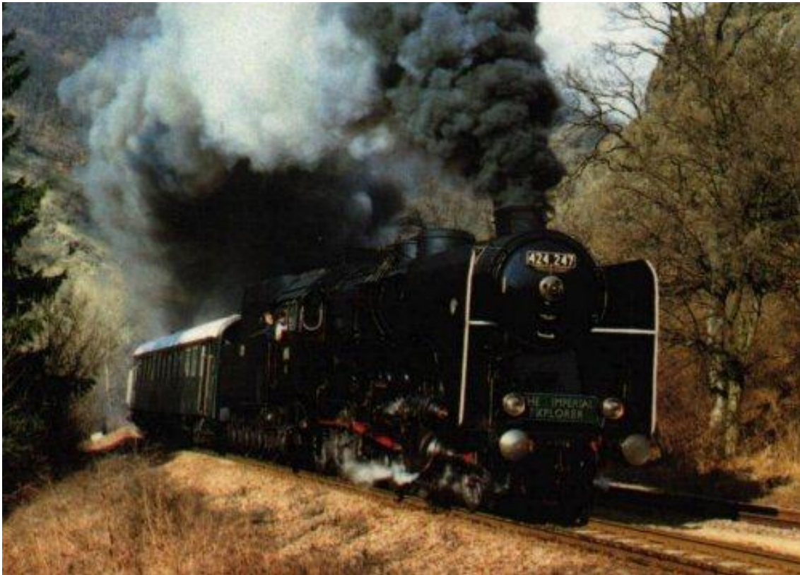
A MÁV leghíresebb gőzmozdonytípusa; a 424-es. Teljesítménye 1350-1500 LE volt szén- és kazántípustól függően, maximális sebessége 90 km/h
