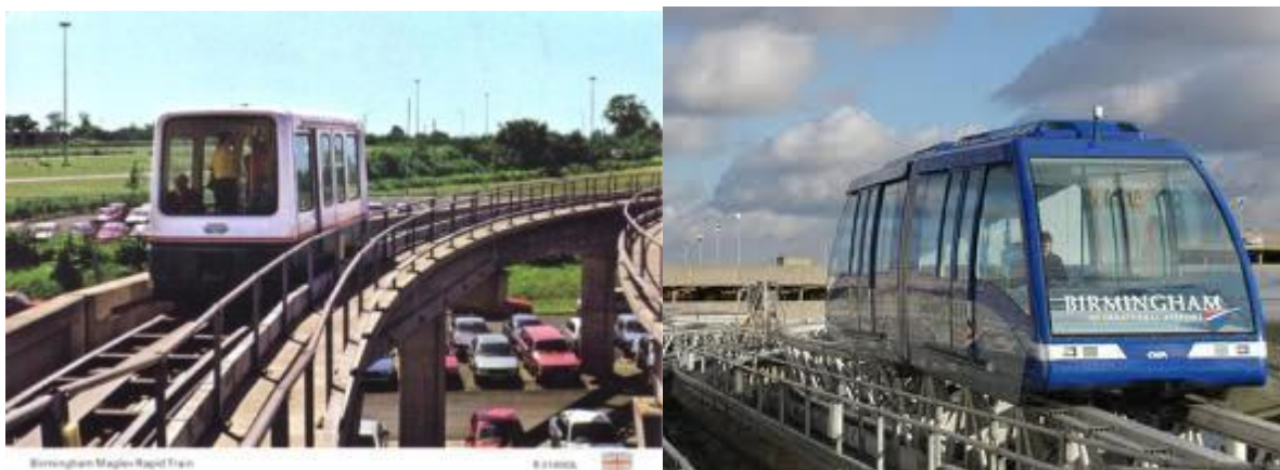
A Birmingham Maglev egyik kocsija a 80-as években (balra), és az új drótkötél-vontatású AirRail Link napjainkban (jobbra)
