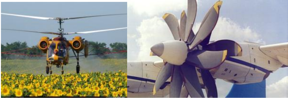
Balra fent: Kamov Ka-26-os szovjet permetező helikopter. Koaxiális elrendezése miatt nem kell farokrotort alkalmaznia, fordulni a rotorok fordulatszám-különbségének változtatásával tud. Jobbra fent: Egy Antonov An-70-es kettős légcsavarkoszorúja. Lent: Airbus A400M „Grizzly” a világ legmodernebb légcsavaros gépe. Baloldali motorjai az óramutatóé-, a jobboldaliak azzal ellentétes irányba forognak
