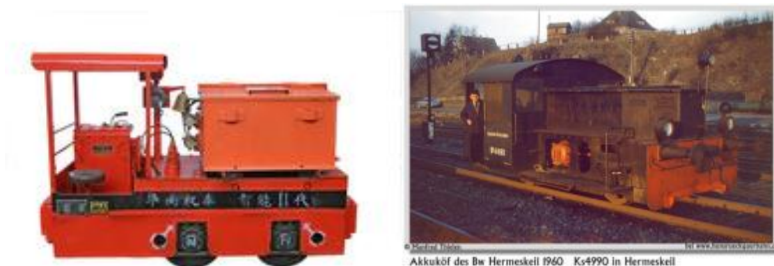
Egy 760 mm-es keskeny nyomközű bányamozdony Kínából (balra fent) illetve a DB381-es (jobbra fent) és a DB382-es sorozatú német akkus tolatómozdonyok
