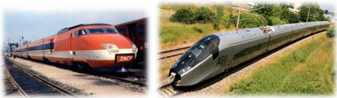
Balra: A TGV-001-es kísérleti gázturbinás motorvonat. Jobbra: A TGV motorvonatok legújabb generációja: az AGV. Utazósebessége 360 km/h, teljesítménye 16 000 LE. 2012-től áll forgalomba Olaszországban Nápoly és Milano között
