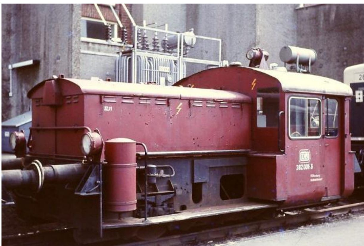
Egy 760 mm-es keskeny nyomközű bányamozdony Kínából (balra fent) illetve a DB381-es (jobbra fent) és a DB382-es sorozatú német akkus tolatómozdonyok
