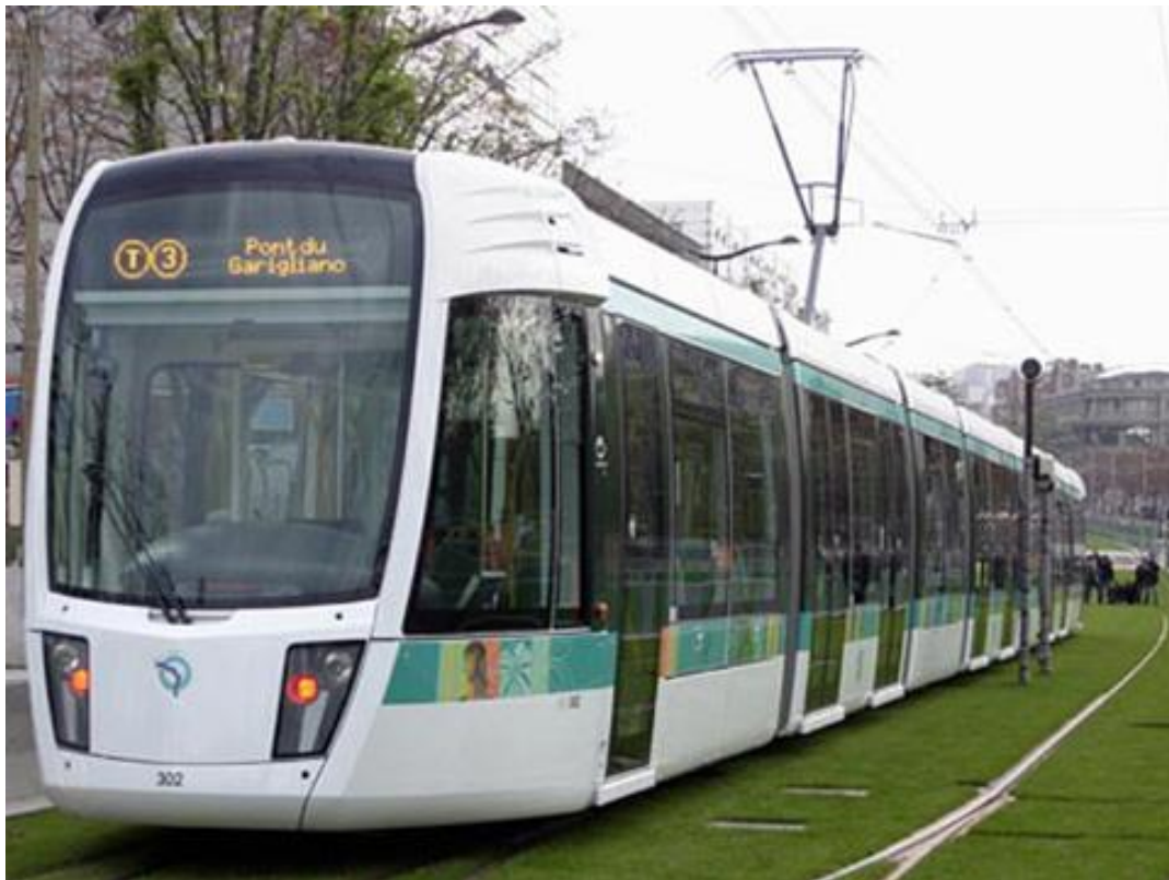
A párizsi Alstom Citadis STEEM szuperkondenzátoros segédhajtású villamos
