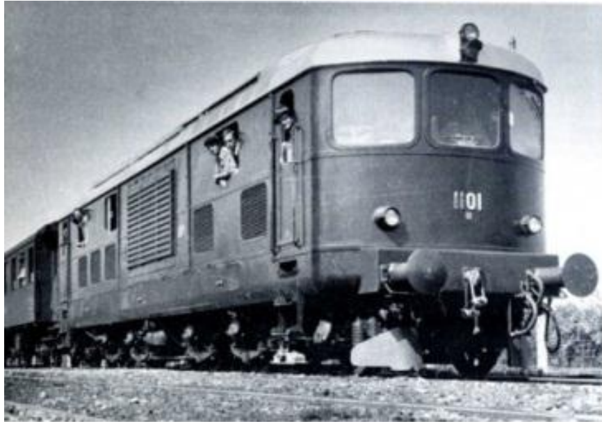
176/379 Zwei verschiedene Aufnahmen aus der Anfangszeit des Betriebes der Gasturbinen-Lokomotive Am 4/6 Nr. 1101. Sie 1941 gebaut, wurde dann die Lokomotive eingehend während Jahren erprobt, bis sie Anfang Oktober 1944 von den SBB in den Rollmaterialbestand übernommen wurde. Sie war eine Entwicklung der BBC, die in der ganzen Welt ihre Nachfolger fand. Insbesondere in Ländern mit eigenen Rohöquellen und geringen Wasservorkommen ist sie für lange Streckenabschnitte geeignet. Für die Schweiz mit der kurzen Stationsfolge war der Loktyp weniger günstig. Die Fotos entstanden 1942 (oben) und 1947 (unten). (Fotos E. Klingenhoff)
