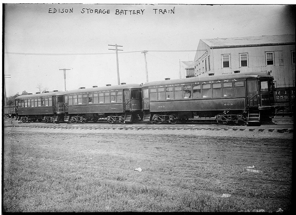
Az USA-ban épült kísérleti Edison-Beach akkumulátoros motorvonat 1912-ből
