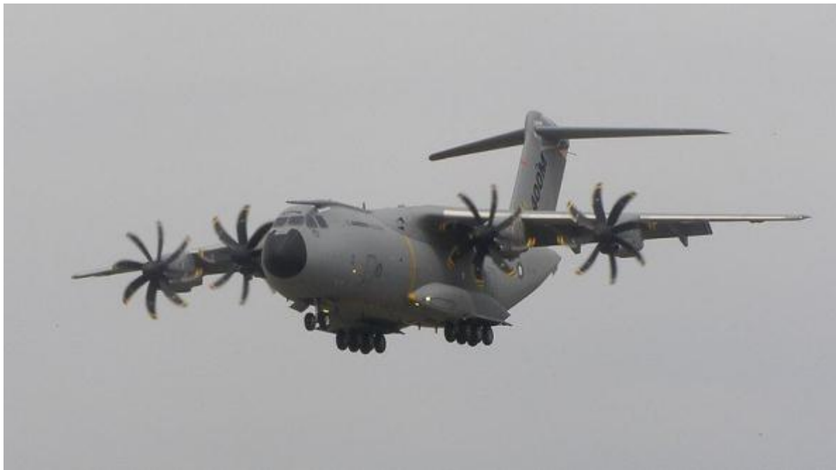
Balra fent: Kamov Ka-26-os szovjet permetező helikopter. Koaxiális elrendezése miatt nem kell farokrotort alkalmaznia, fordulni a rotorok fordulatszám-különbségének változtatásával tud. Jobbra fent: Egy Antonov An-70-es kettős légcsavarkoszorúja. Lent: Airbus A400M „Grizzly” a világ legmodernebb légcsavaros gépe. Baloldali motorjai az óramutatóé-, a jobboldaliak azzal ellentétes irányba forognak
