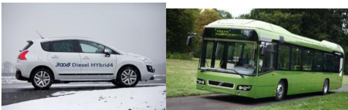
Balra fent: Peugeot 3008 Diesel Hybrid4, a világ első sorozatgyártású dízelhibrid személyautója. Az összkerekes jármű hátsó kerekeit egy 37 lóerős villanymotor forgatja, az elsőket egy 163 lóerős turbódízel, norma szerinti fogyasztása 3,9 l/100 km. Jobbra fent: Volvo 7700 Hybrid autóbusz. Az eredeti változat 9 literes motorja helyett ebben csak 5 literes található, kiegészítve Li-ion akkumulátorokkal. Fogyasztása 30 %-kal kisebb, miközben csak 100 kg-mal nehezebb. Lent: az amerikai Peterbilt gyár hibrid teherautó-palettája
