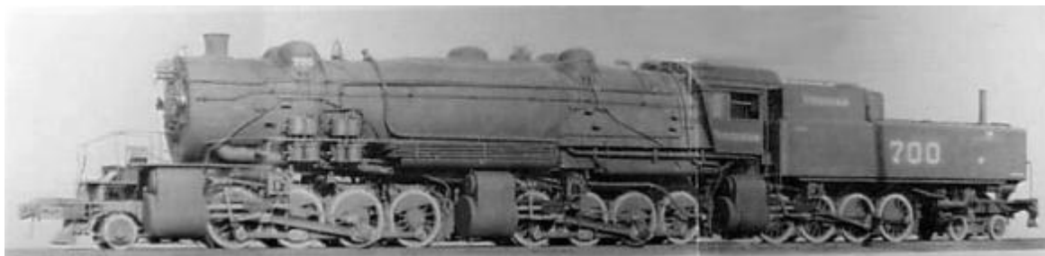
Fent: a még nagyobb 2-8-8-4 Virginian Triplex mozdony. Lent: a 2-8-8-0-s csuklós (balra) és a 2-8-0-s szimpla gőzmozdony, amelyeket 1920-ban az óriási gőzös „feldarabolásával” építettek meg
