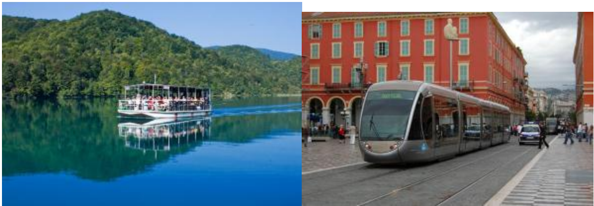
Balra: A horvátországi Plitvicei Nemzeti Parkban üzemelő 7 darab elektromos hajó egyike. Jobbra: Az Alstom Citedis gyártmányú akkumulátoros villamosai nem igényelnek felsővezetékét. A kép Nizzában készült.
