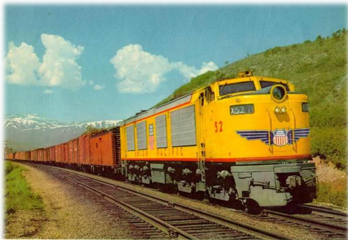
Az 52-es pályaszámú, első generációs, 4500 lóerős Union Pacific gázturbinás
