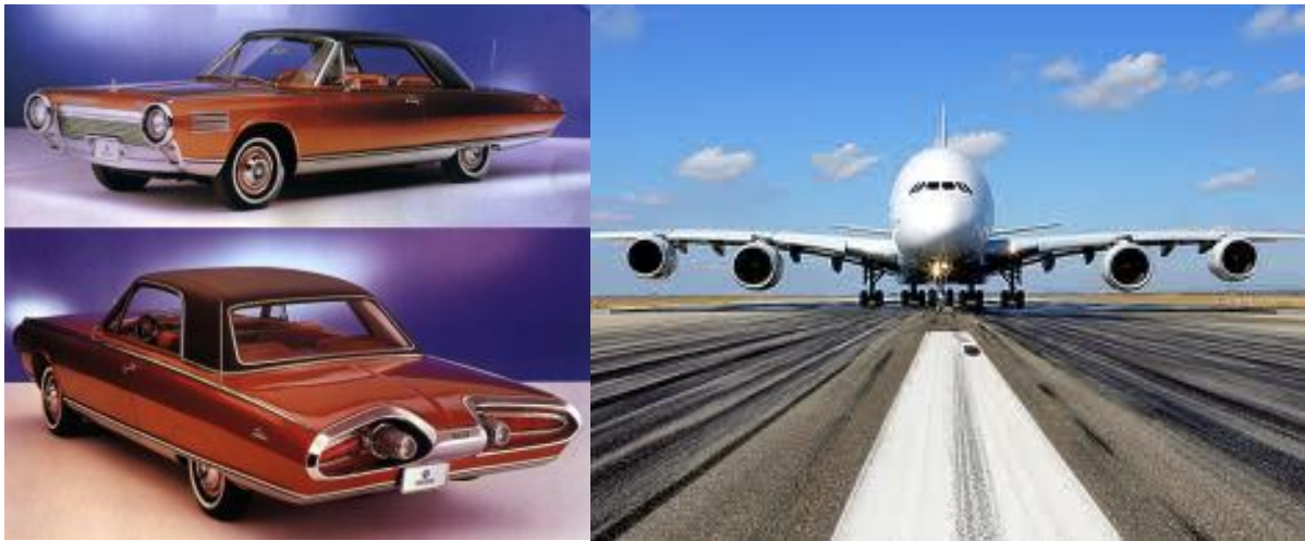
Balra: Chrysler Turbine kísérleti gázturbinás autó: teljesítménye 130 LE, fogyasztása 25 l/100 km. Jobbra: Airbus A380, a világ legnagyobb utasszállító repülőgépe: teljesítménye kb. 300 000 LE, fogyasztás 2,9 liter/ülőhely/100 km
