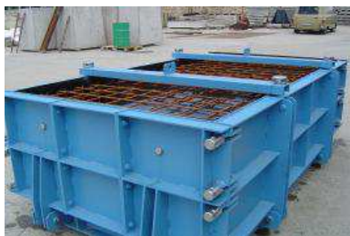
22. ábra: Betonöntő sablon
