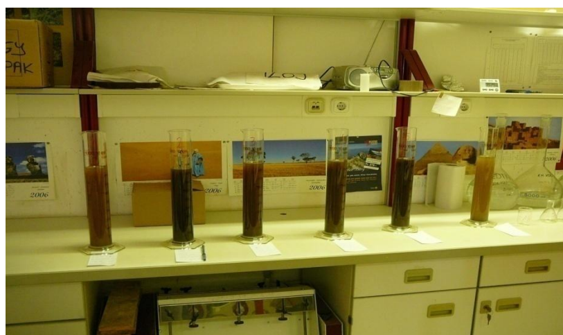
12. ÁBRA A MECHANIKAI ÖSSZETÉTEL MEGHATÁROZÁSA KÖZBEN ÜLEPEDŐ MINTÁK (SAJÁT FELVÉTEL)
