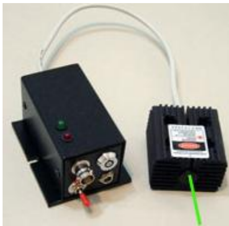
10. ábra: A fotoakusztikus mérésekhez használt diódalézer és tápegysége, illetve a lézer stabilitása az idő függvényében
