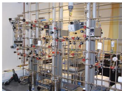
23. ábra: A CuO-os oxidáló vákuum technika (Horváth Zsolt felvétele)
