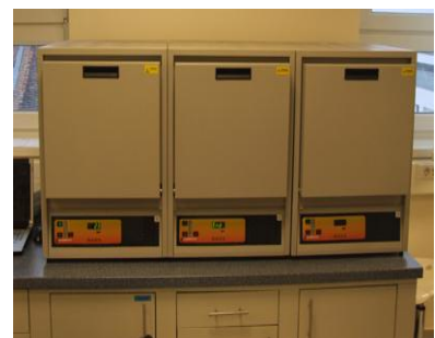
25. ábra: A titán-hidrides redukcióhoz használt kemencék (Horváth Zsolt felvétele)
