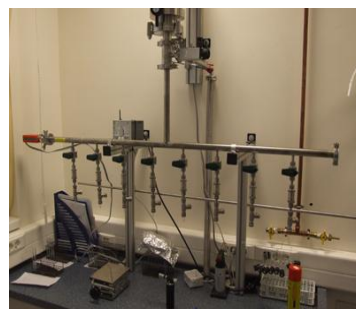
24. ábra: A titán-hidrides redukcióhoz előkészítő vákuum technika
