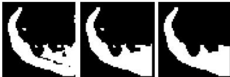
2.2-5. ábra Első képen az eredeti kép állapota, a második képen a zárás utáni állapot, a harmadik képen a nyitás utáni állapot látható. ( a kép az [5] -ös referenciából való)
