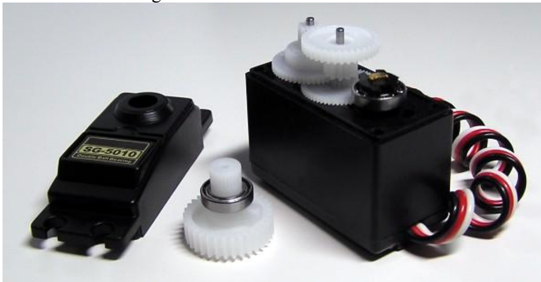
15. ábra Általam használt szervó mechanikai felépítése (áttétel) [7]
