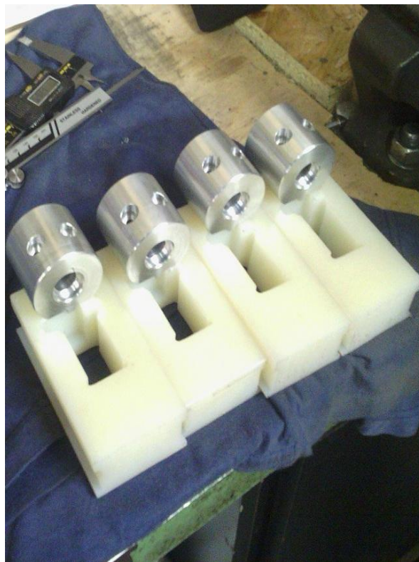
22. ábra Csapágyház valamint csúszó lapok megmunkálása
