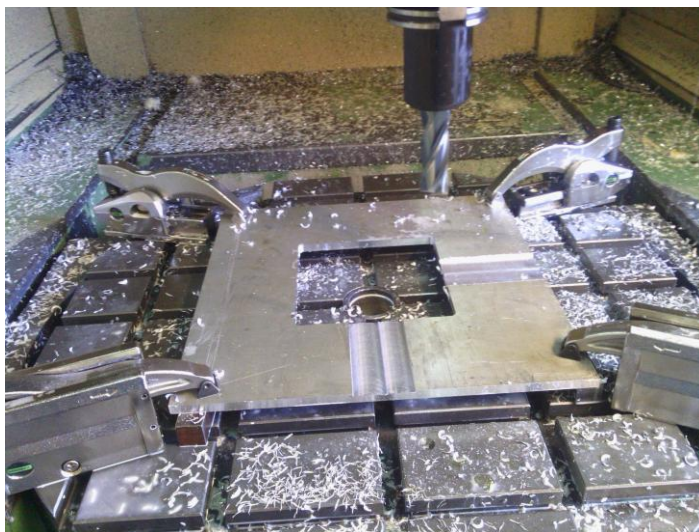
23. ábra Alaplap valamint csúszó keret távtartó megmunkálása
