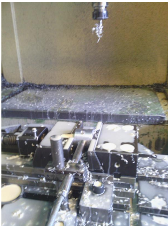
22. ábra Csapágyház valamint csúszó lapok megmunkálása
