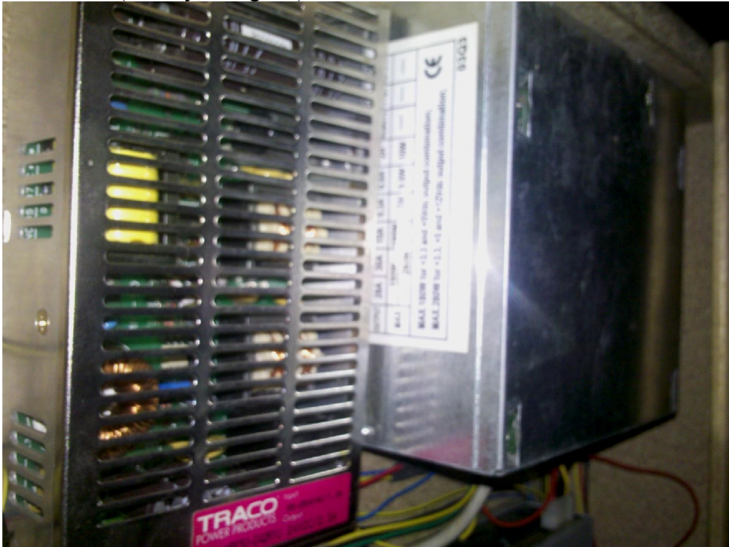
29. ábra: PLC táp (jobb) és ATX táp (bal)
