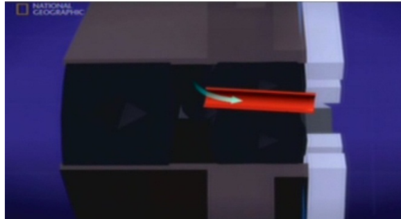
A felesleges víz kivezetése az üvegtáblákra
