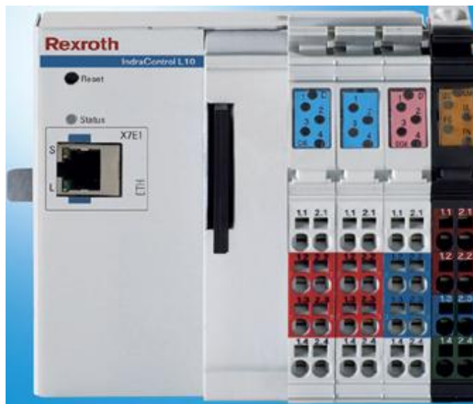
2. ábra. Indra Logic L10 típusú PLC
