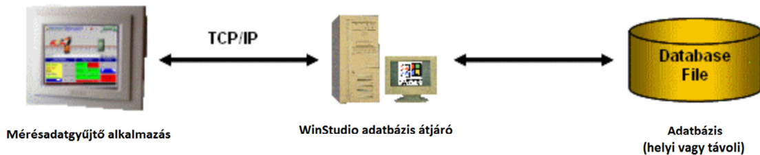
26. ábra: A mérésadatgyűjtő fedélzeti alkalmazás együttműködése az adatbázis átjáróval
