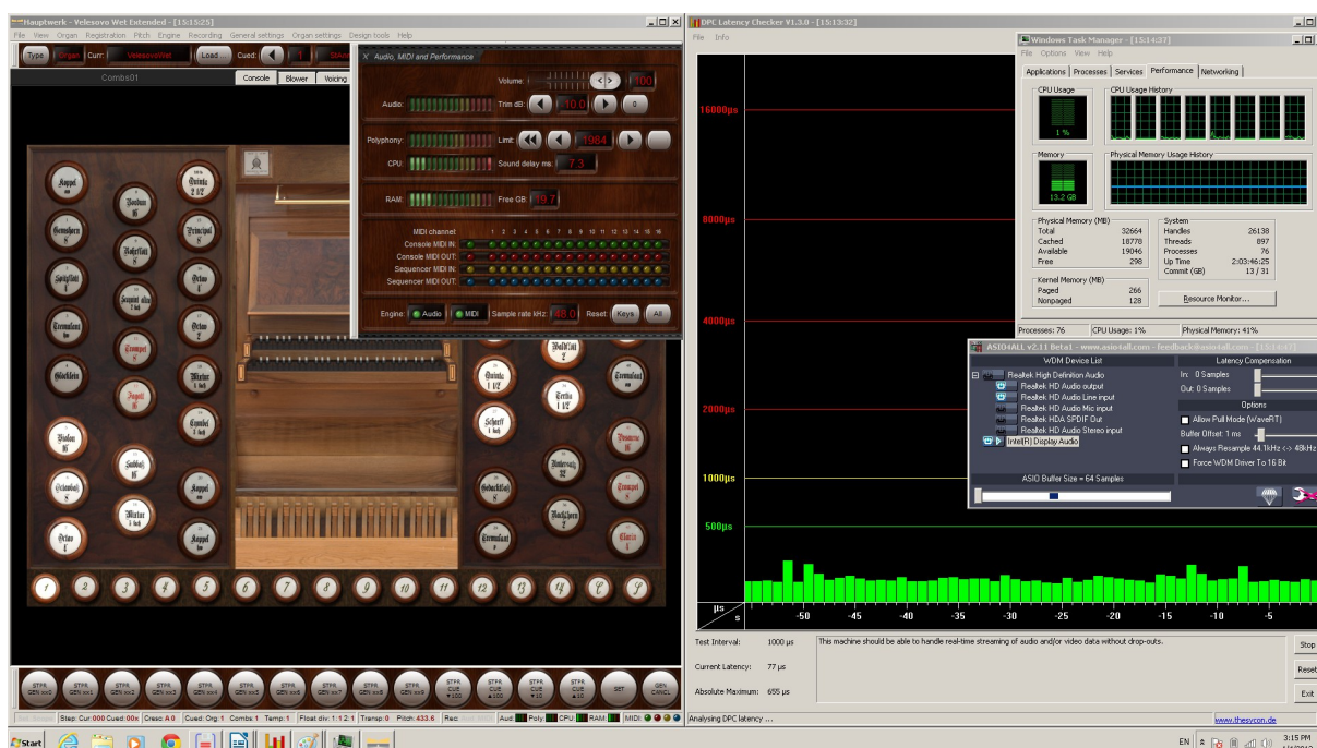
21.Ábra: Velesovo orgona betöltve, mindenféle konfigurációs és diagnosztikai ablak is látható: DPC Latency Checker, Feladatkezelő, ASIO4ALL univerzális alacsony késleltetésű driver konfigurációs ablaka
