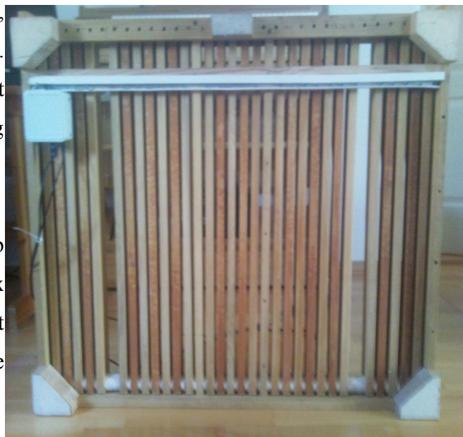
12.ábra: Orgona Pedál hátulja. Látható a szerelődoboz, a lécs és a műanyag takaró.
