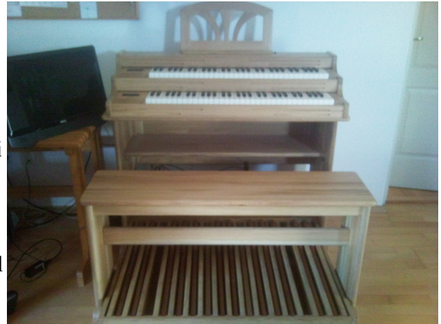
16.ábra: A kész orgonakonzol. Balra az érintőképernyő látható Forrás: Saját fénykép
