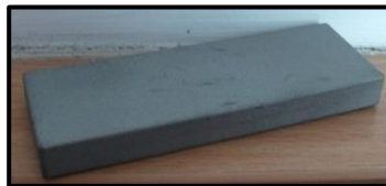
28. ábra. Nyers test a keménység mérésére
