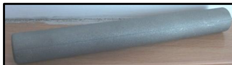
25. ábra. Nyers szakítási próbatest
