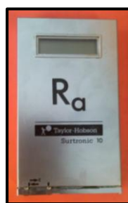
31. ábra. Taylor-Hobson Surtronic 10 R_a felületi érdességmérő
