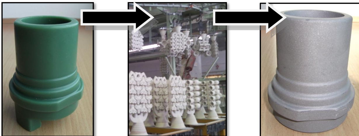
36. ábra. Bicskén még 1.4308 acélból megmunkált darabot a mi vizsgálataink miatt 1.4469-ből legyártották
