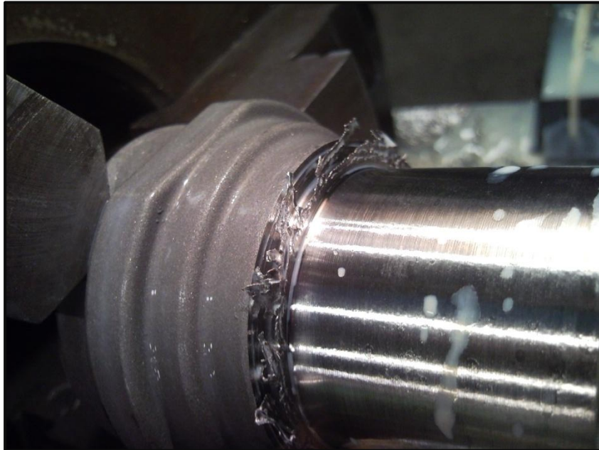
46. ábra. Sorjaképződés az utolsó fogásvételkor – n=467 [ford/min] f=0,14 [mm/ford]
