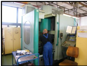
16. ábra. Deckel Maho DMC 70V, NCT-EmR 1020D és NCT TMV 1050A CNC megmunkáló központon végzett marási művelet
