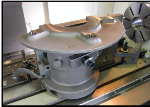
15. ábra. Marási művelet NCT-EmR 1020D CNC megmunkáló központon
