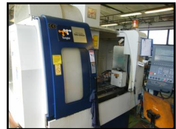
16. ábra. Deckel Maho DMC 70V, NCT-EmR 1020D és NCT TMV 1050A CNC megmunkáló központon végzett marási művelet
