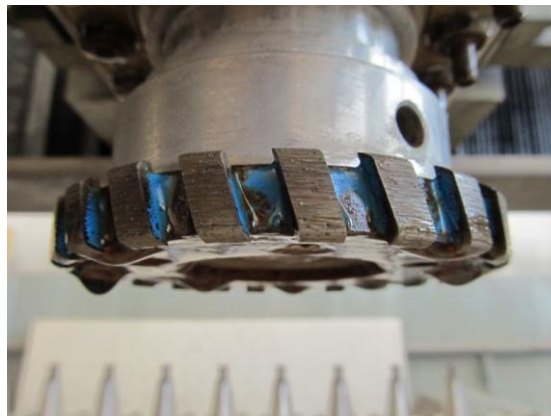
2.5. ábra Az iparban alkalmazott szegmenses gyémántszemcsés kőmaró szerszám (Woldem Kft.)
