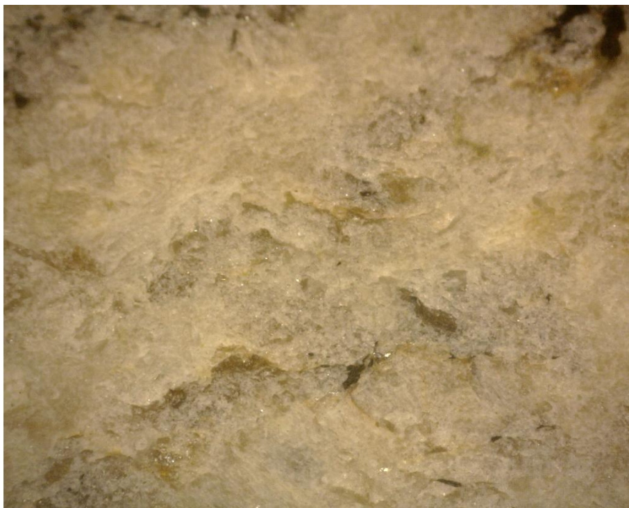
6.2. ábra 30-szoros nagyításban készült mikroszkópos felvétel a Giallo Farfalla gránit felületéről
