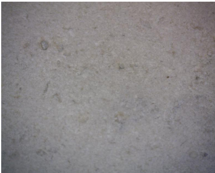
6.4. ábra A Süttői forrásvízi mészkő 30-szoros nagyítású mikroszkópos képe
