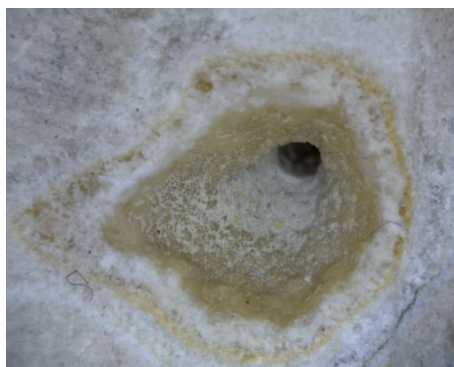
7.13. ábra A Süttői mészkő felszínén található üreg 30-szoros nagyításban
