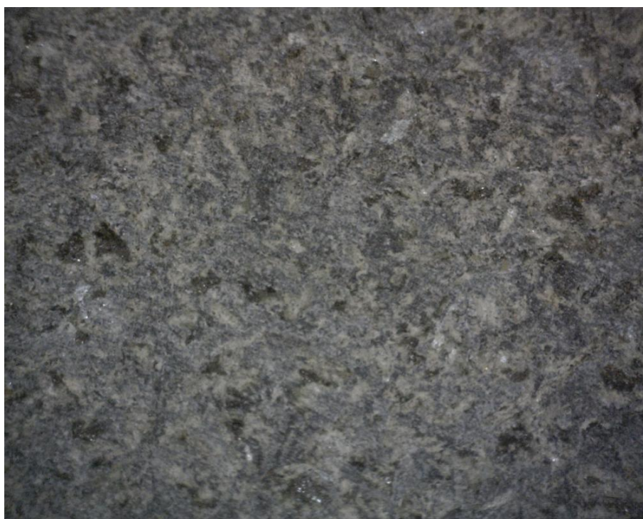
6.3. ábra A G684 Gabbro 30-szoros nagyításban készült mikroszkópos felvétele
