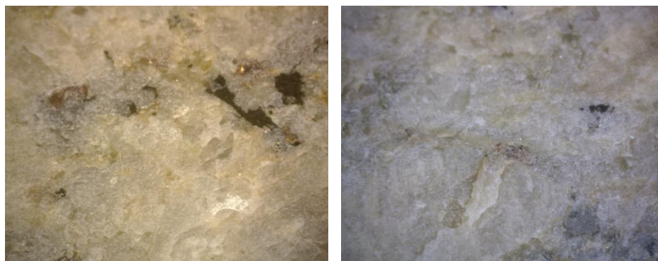
7.6. ábra A Giallo Farfalla gránit felszínén tapasztalható felületi hibák az 5. mérési pont környezetében
