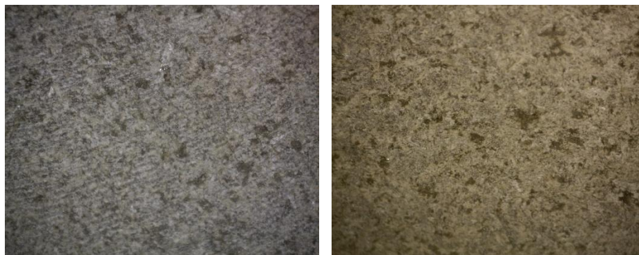
7.9. ábra A G684-es gabbro felszíne a 3. mérési pontban 1200 1/perc-es (balra) és 5200 1/perc-es (jobbra) fordulatszámon
