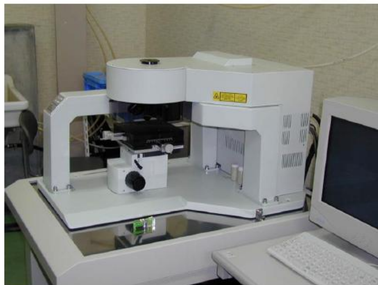
2.7. ábra Olympus OLS 1100Konfokális lézeres elektronmikroszkóp (forrás: Chae [10], 184. oldal 1. ábra)
