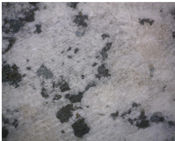
7.15. ábra A Rosa Beta gránit felszíne 600 1/perc-es fordulatszámmal történő megmunkálás után az 1. mérési pont környezetében
