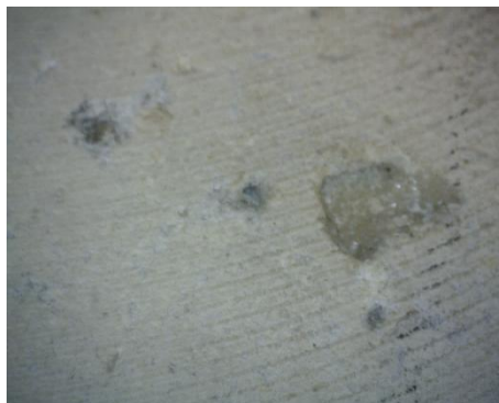
7.14. ábra A Süttöi mészkő felszíne a 600 1/perc-es fordulatszámmal megmunkált sávban, a kilépőél környezetében, a képen megfigyelhetők a mészkő pórusai
